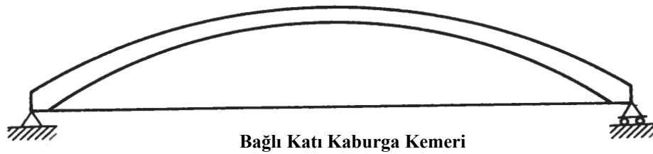
Şekil 2.83. Modern Kemerlerdeki Bağlı Katı Kaburga Kemerı (Sonavane, 2014).
