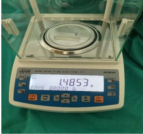
Resim 9. 40 numaralı boş eppendorf tüpünün 10^{-4} hassas terazide tartılması
