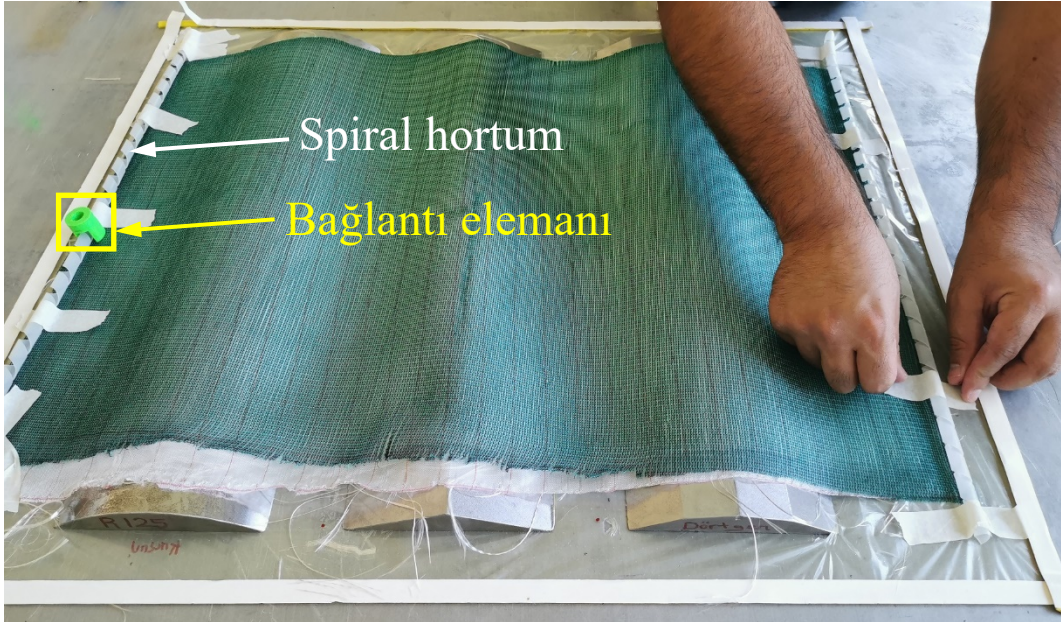
Şekil 4.8. Akış filesi ve spiral hortumların yerleştirilmesi.
