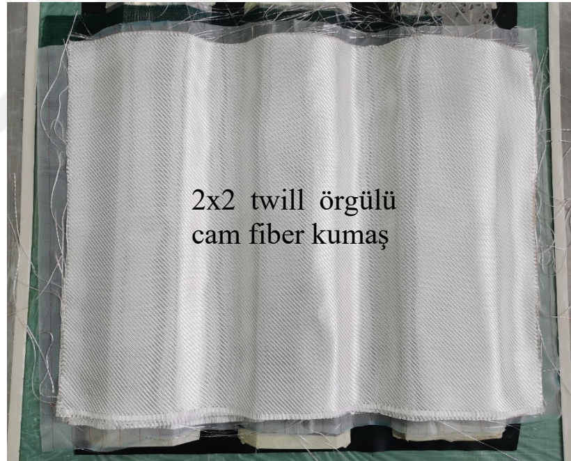
Şekil 4.6. Örgülü cam fiber dokuma kumaş ve kauçuk ara tabakaların dizilimi.
