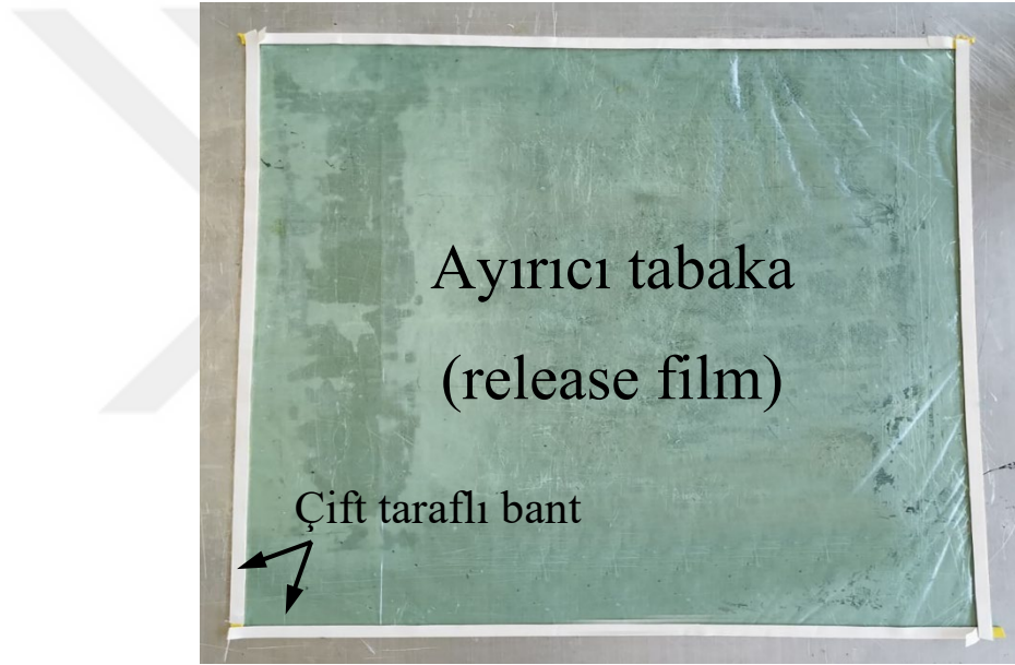
Şekil 4.4. Ayırıcı tabakanın tezgâha çift taraflı bant ile yapıştırılması.
