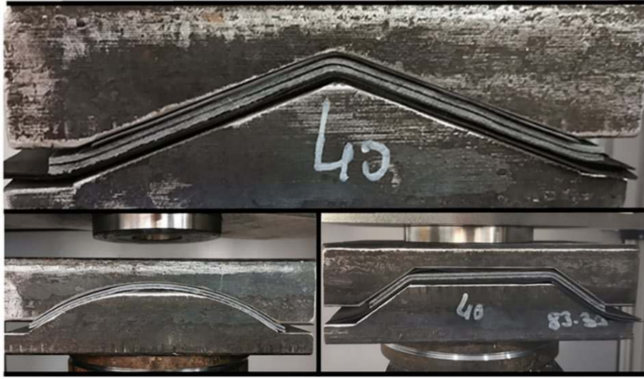
Şekil 4.32. Numunelerin eğri yüzeyli mesnetler arasına yerleştirilmesi.
