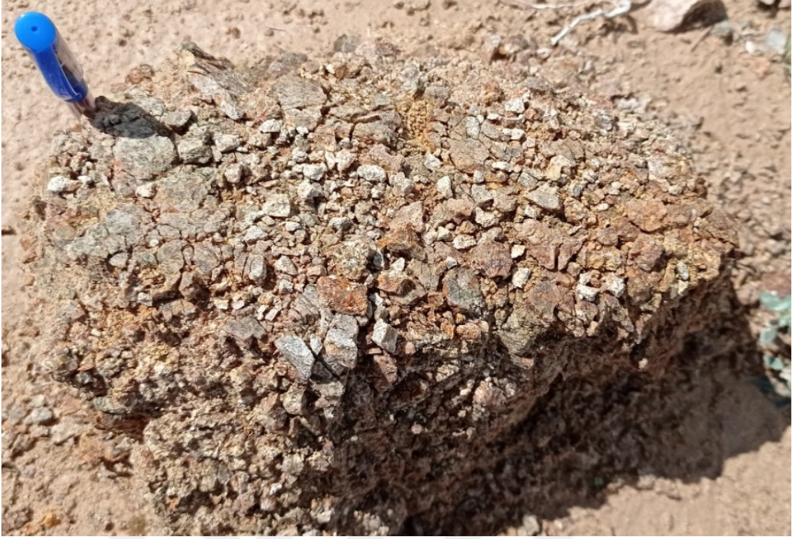
Şekil 2.10. Sarımsı-grimsi pas renkli sit-kum-çakıl boyutunda ayrışarak arenalaşmış kaba saprolit örneği
