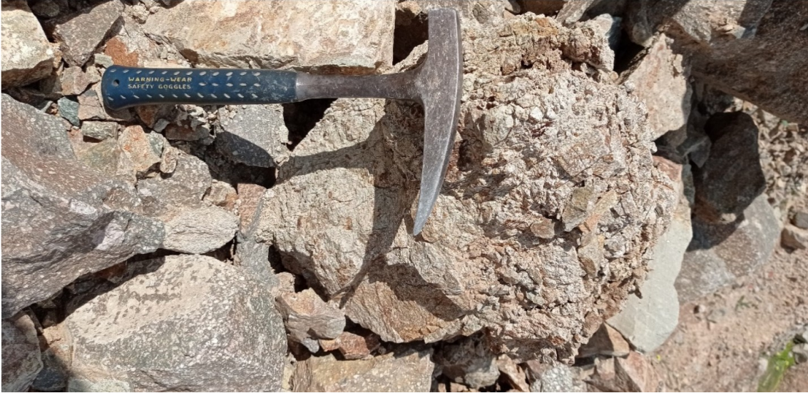
Şekil 2.11. Sarımsı-grimsi pas renkli sit-kum-çakıl boyutunda ayrışma sürecindeki kaba saprolit örneği.
