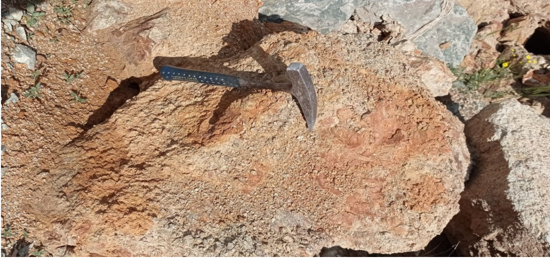
Şekil 2.12. Sarımsı-grimsi pas renkli sit-kum-çakıl boyutunda ayrışma sürecindeki kaba saprolit örneği.
