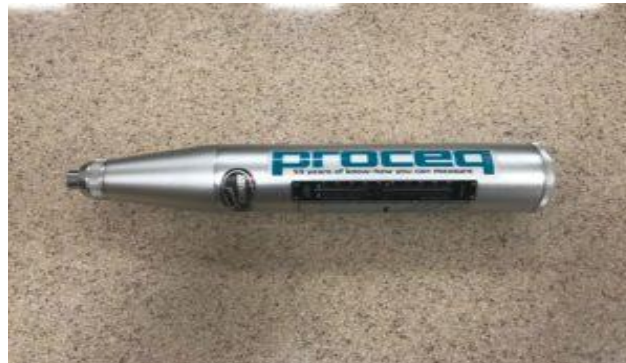
Resim 3.4 Sertlik ölçümü deneylerinde kullanılan L tipi Schmidt çekici.
