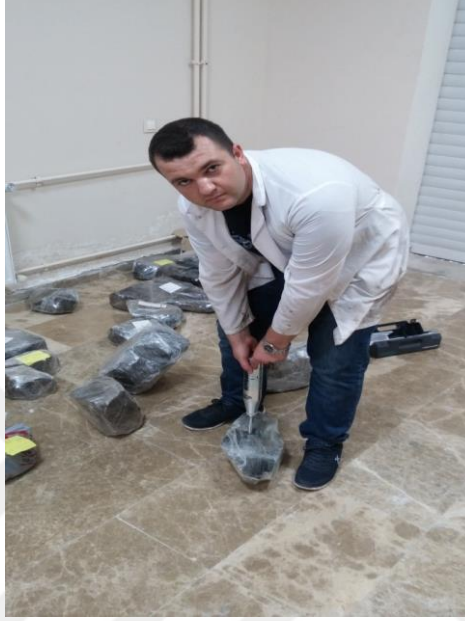
Resim 3.5 Schmidt sertlik ölçüm deneylerinin yapılışından bir kesit.
