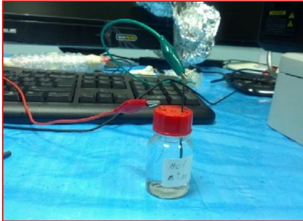
Şekil 24: EIS cihazı ile Ag telin ince bir gümüş klorür (AgCl) tabakasıyla kaplanması
