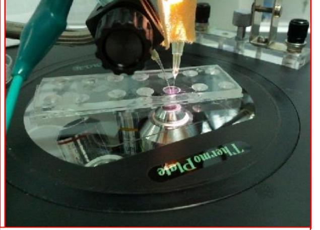
Şekil 38: Hazırladığımız mikroçip içinde referans elektrotun yerleşimi
