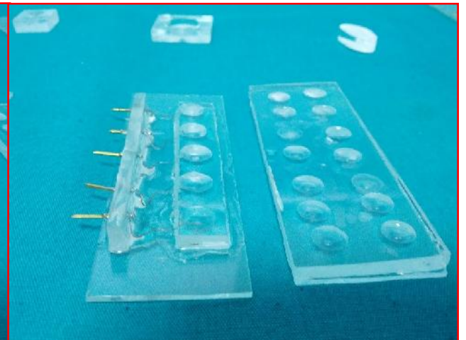
Şekil 17: EIS ölçümü için 14 haneli oosit mikroçipi
