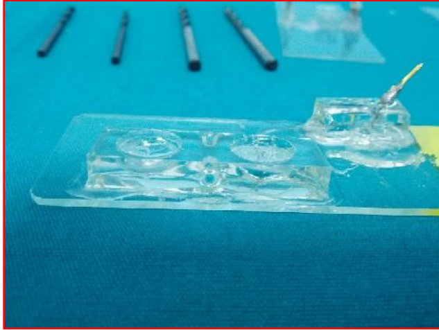
Şekil 14: EIS için hazırladığımız tek haneli oosit mikroçipi
