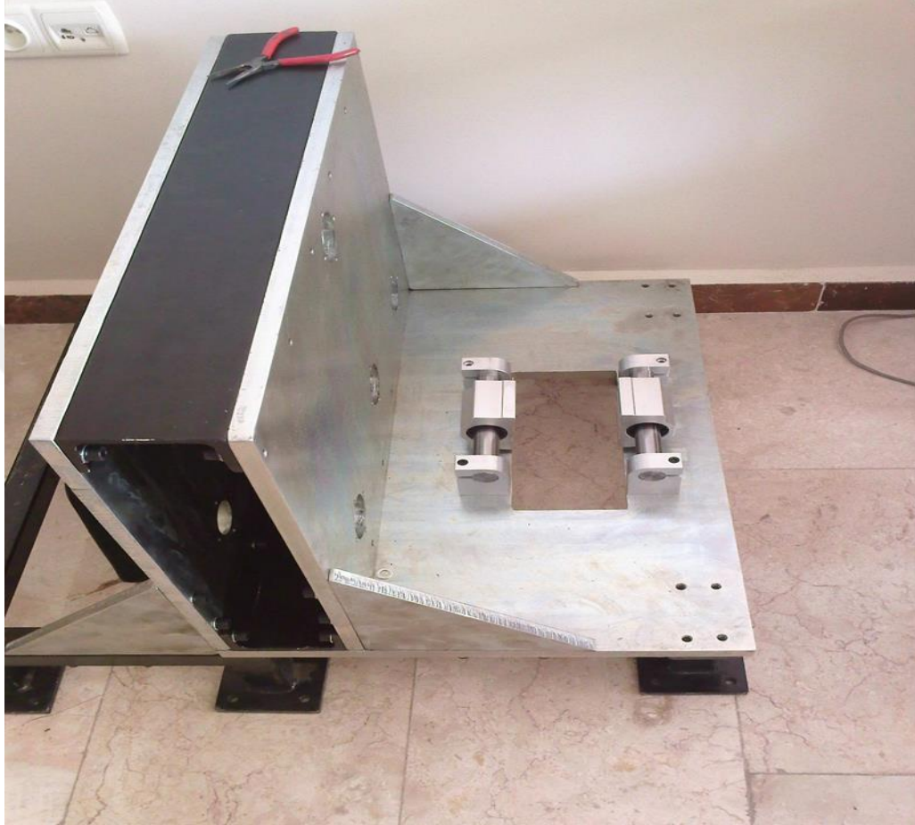
Şekil 4.6. Makine şasisinin montajı
