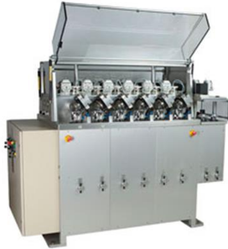
Şekil 2.9. ADL kalça simülatörü [39].
