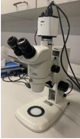
Şekil 3.18: Nikon SMZ745T Stereomikroskop.
