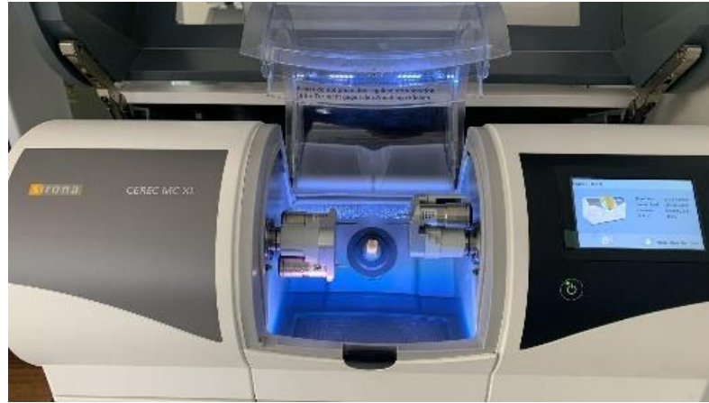
Şekil 3.13: Cerec MC XL Kazıma Cihazında Cerasmart 270 Blokların Kazınması.
