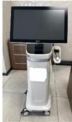
Şekil 3.20: Sirona Primescan Ağız İçi Tarayıcı.
