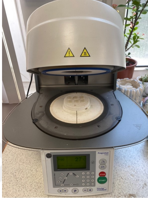
Resim 10. E.max CAD örneklere kristalizasyon ve glaze işleminin uygulanması
