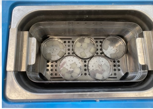
Resim 8. Örneklerin distile su içerisinde ultrasonik olarak temizlenmesi
