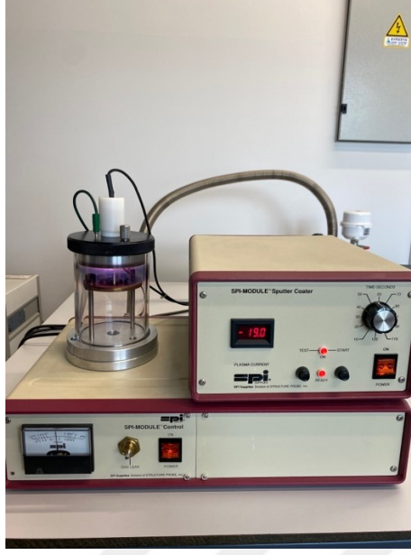
Resim 23. Örneklerin altın palladyum alaşımı ile kaplanması
