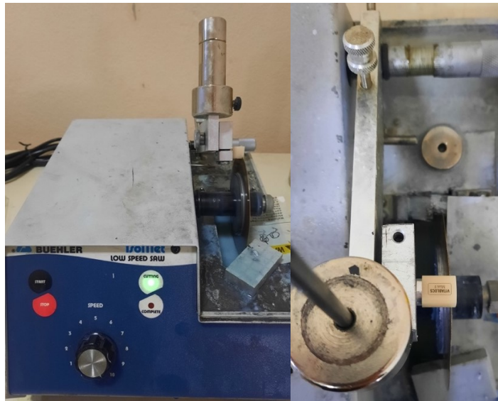
Resim 5. Düşük hızlı hassas kesme cihazıyla blokların kesilmesi.
