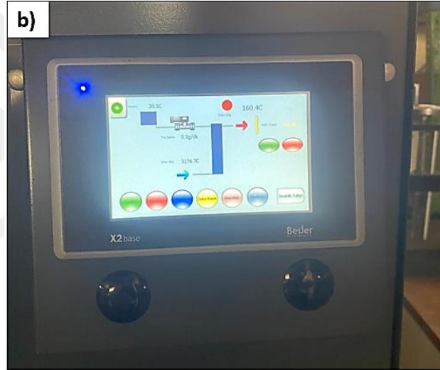
Şekil 4.8. Erozyon test cihazı elektronik bölüm, a) Elektronik kontrol ünitesi ve PLC, b) Gösterge ekranı
