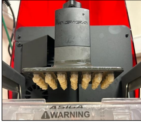
Şekil 2.19. Kronların Asiga 3B yazıcıda basılma aşaması.
