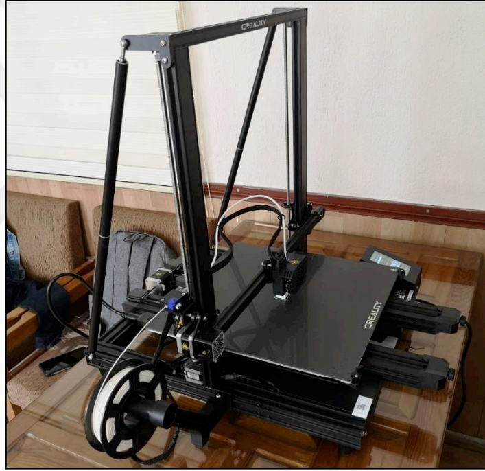
Resim 3.4 Filament basımında kullanılan Creality CR-6 Max 3B yazıcı.
