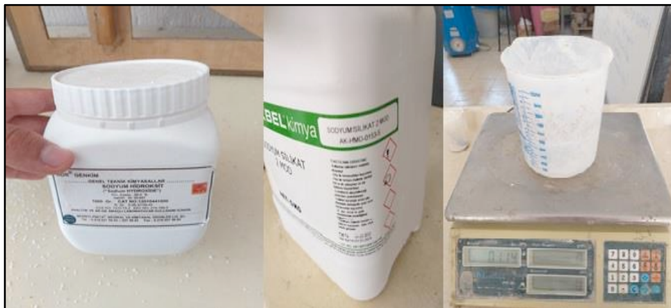
Resim 3.3 Çözelti karışımı, Sodyum hidroksit ve Sodyum silikat.
