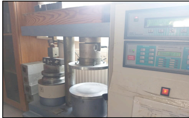
Resim 3.110 Numune üzerinde uygulanan üç noktalı eğilme deneyi.
