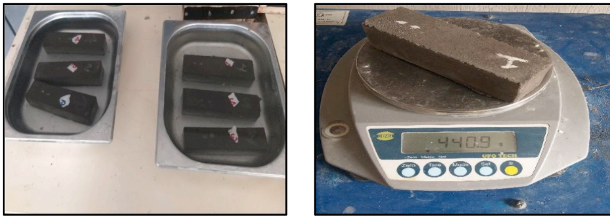
Resim 3.10 Numunelerin suda bekletilmesi ve ağırlık ölçümleri.
