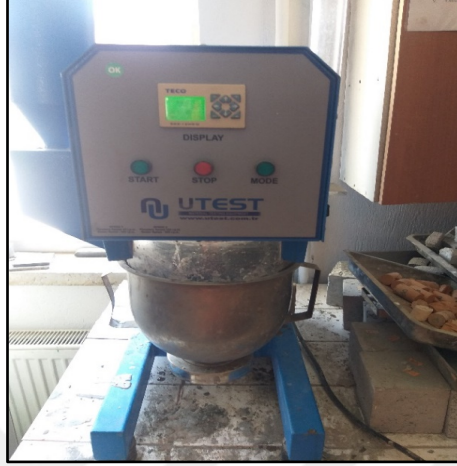
Resim 3.7 Harcın hazırlanmasında kullanılan hobart mikseri.
