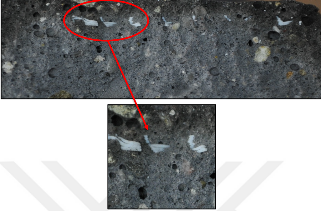
Resim 20.7 PETG – 2 mm – sarmal şekilli ızgara görseli.
