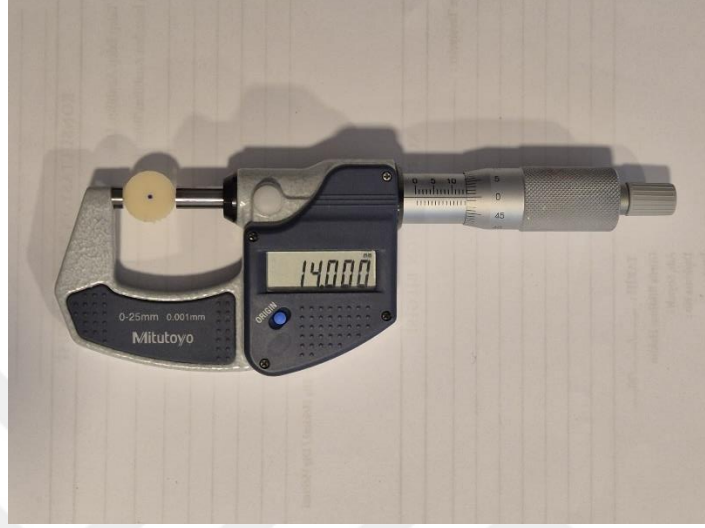
Şekil 3.13. Disk şeklindeki 3B örneklerin dijital kumpas ile çap ölçümü
