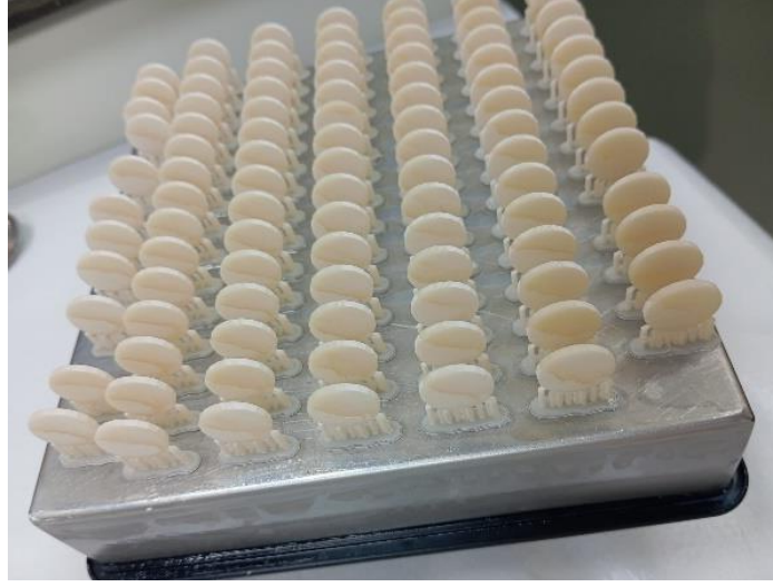
Şekil 3.3. Dikey yönde üretilen disk şeklindeki 3B örnekler
