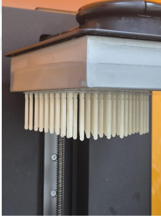
Şekil 3.4. Dikey yönde üretilen prizmatik 3B örnekler
