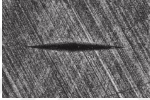
Şekil 2.10. Knoop girinti ucunun mikroskop görüntüsü (20)
