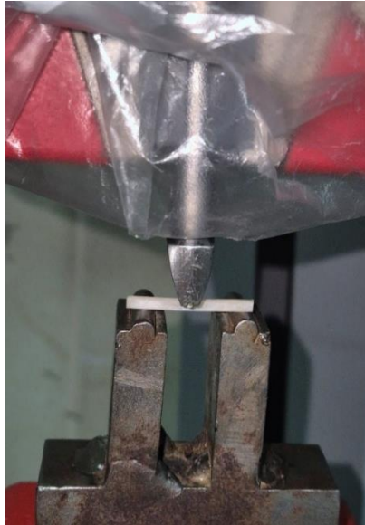
Şekil 3.11. 3B örneğe test fikstüründe 3 nokta eğilme testinin uygulanması
