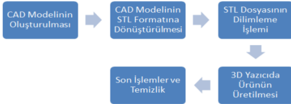
Şekil 2.1 Eklemeli imalat metodu işlem adımları (Karabıyık ve Apak, 2021)
