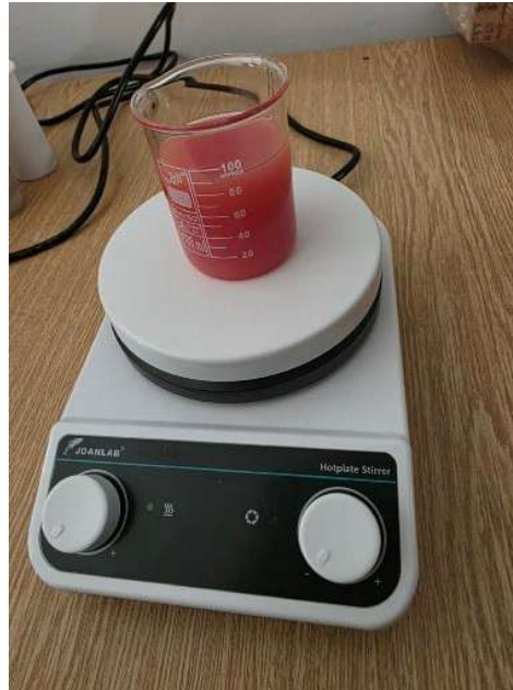
Şekil 4.17. Manyetik karıştırıcı ile karıştırma işlemi
