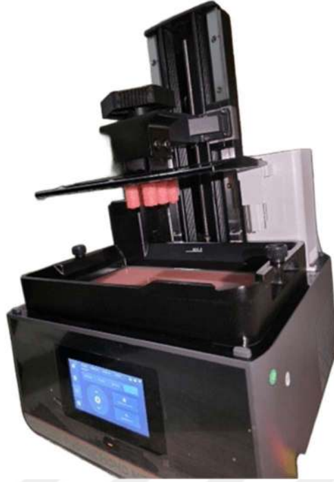
Şekil 4.19. Anycubic Photon Mono M7 Pro SLA/MSLA yazıcı ve yazıcıda biyoreçine ile üretilen ürünler.
