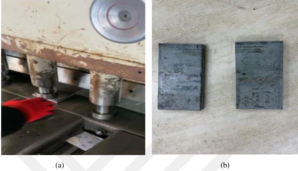
Şekil 7.19 (a) Metal levhanın basma deneyi için giyotin makasında kesilme işlemi (b) Kesim sonrası hali
