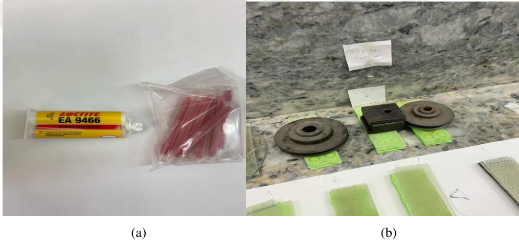
Şekil 6.11 Yapıştırıcı malzemenin kullanılması (a) Epoksi yapıştırıcı (b) Çekirdek yapı ile yüzey örtüsünün yapıştırılması
