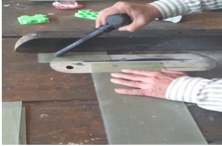
Şekil 6.6 Kompozit tabakanın kesim aşaması
