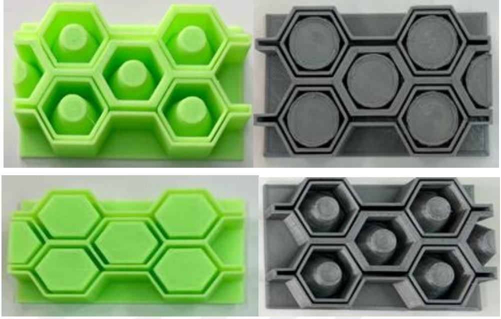
Şekil 6.4 Basma deneyi için hazırlanmış PLA ve ABS malzemelerden üretilmiş numune örnekleri
