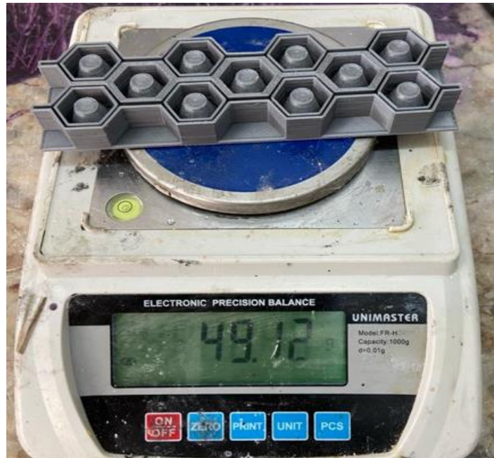
Şekil 6.9 Tip2-PLA (50 mm x 170 mm) kesik koniye ait numunenin tartılma işlemi
