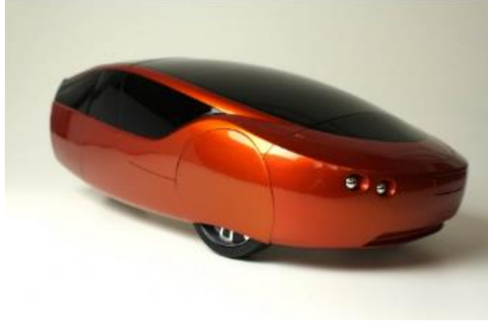
Şekil 3.3 3D yazıcı ile imal edilen ilk araba Urbee [28]
