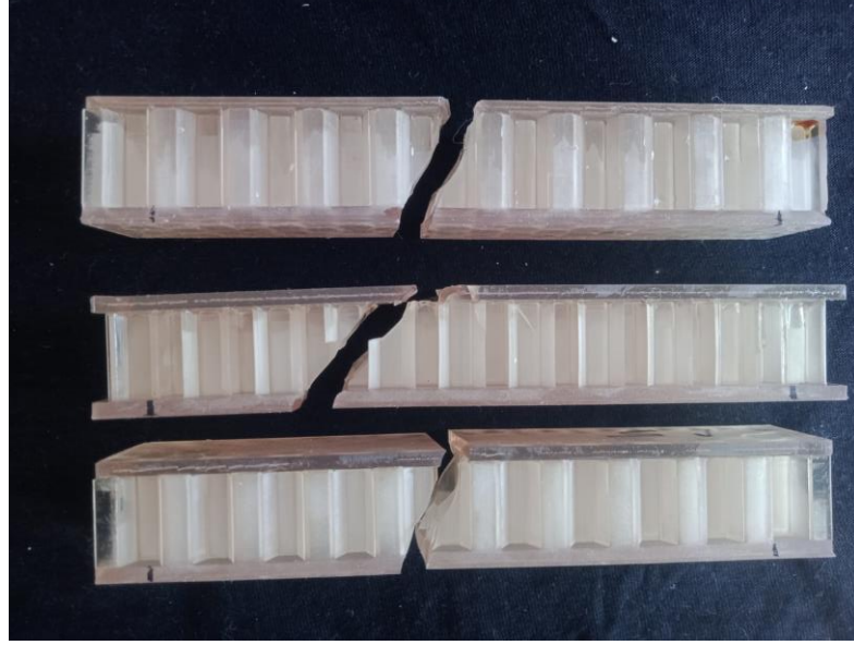
Şekil 4.10 Üç nokta eğme deneyi sonrası numuneler
