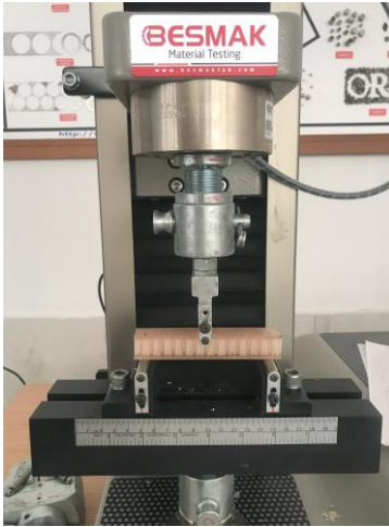
Şekil 3.8 Öksetik hücreli, altıgen hücreli, silindirik hücreli 3 nokta eğme numuneleri
