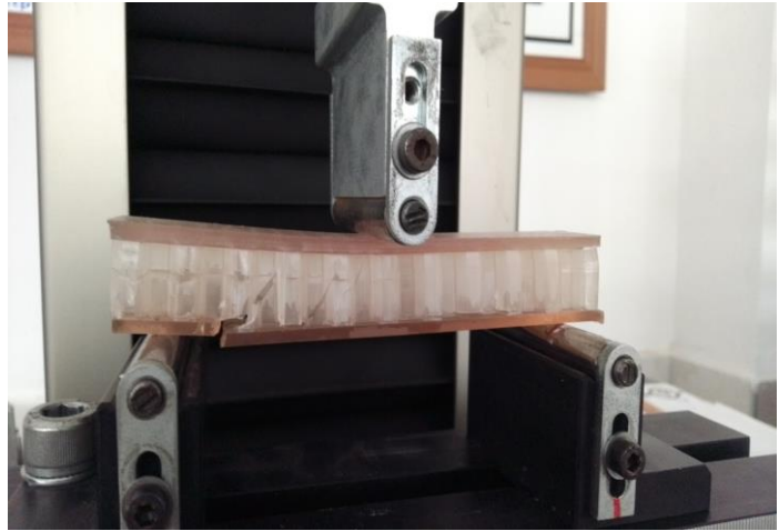
Şekil 3.9 Üç nokta eğme testi
