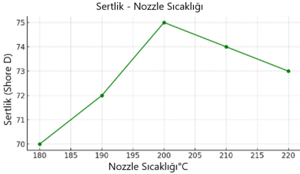
Şekil 2. 17 FDM ile üretilen numunede sertlik ile dolgu sıcaklığı oranı arasındaki ilişki (Jamal 2017)
