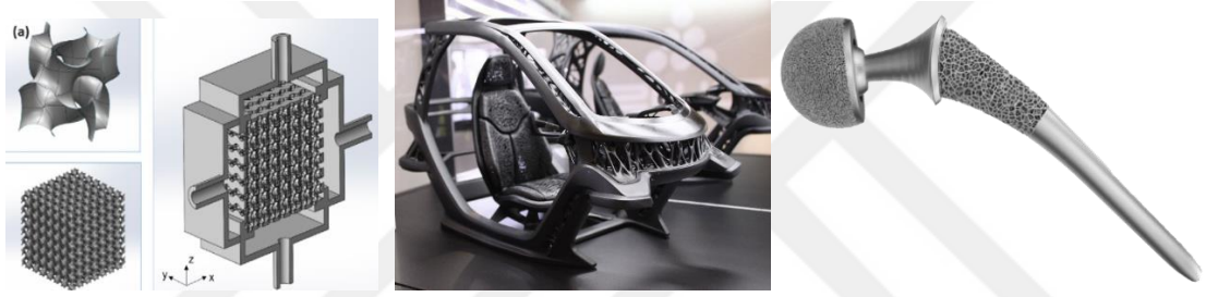
Şekil 2. 3 Kafes yapı kullanılarak üretilmiş olan bazı tasarım örnekleri, a) Isı değiştirici (Dutkowski 2019), b) Araç koltuğu, c) Kalça protezi
