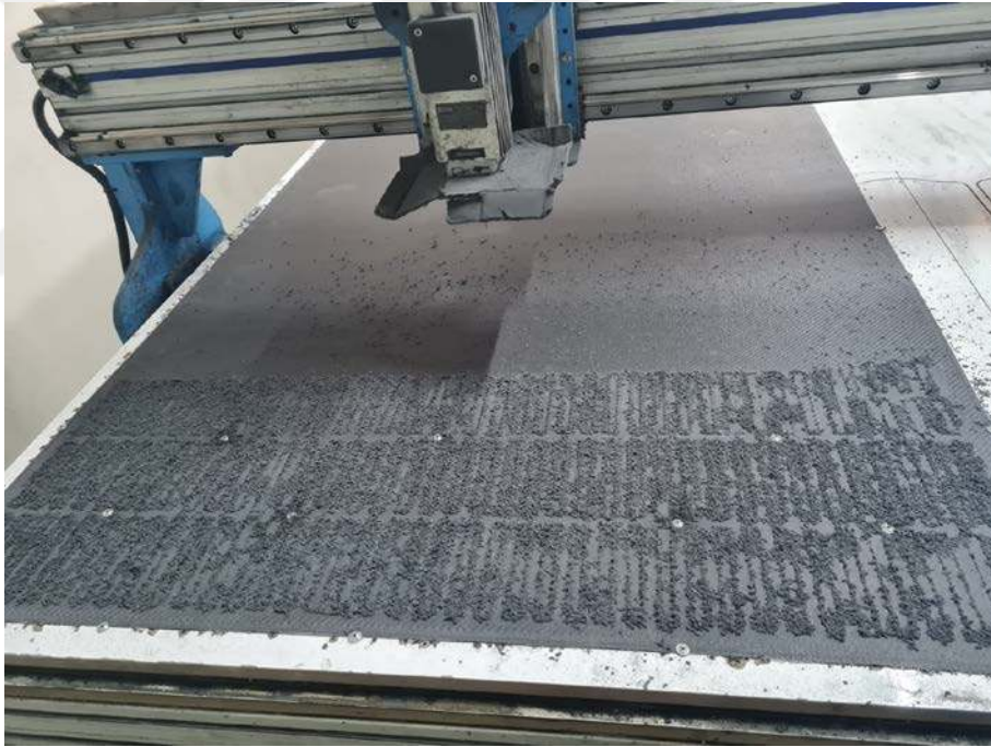
Şekil 2.2. CNC kesim makinası ile üretilen numunelerin kesimi
