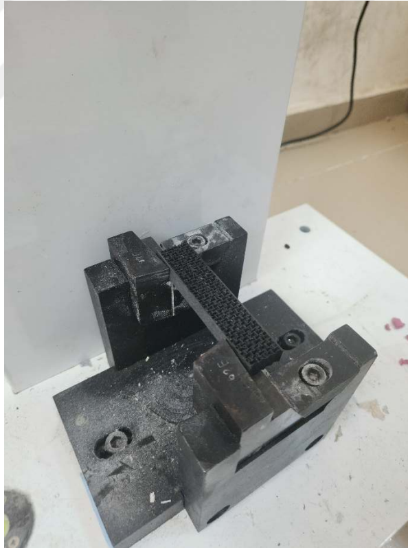
Şekil 3.18.Charpy darbe testi numune pozisyonu
