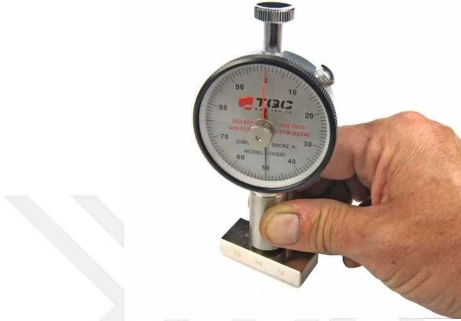
Şekil 2.1. Shore A/D sertlik test cihazı
