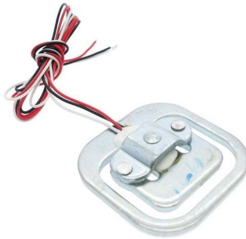
Şekil 3.5. Deneyde kullanılan kuvvet sensörü
