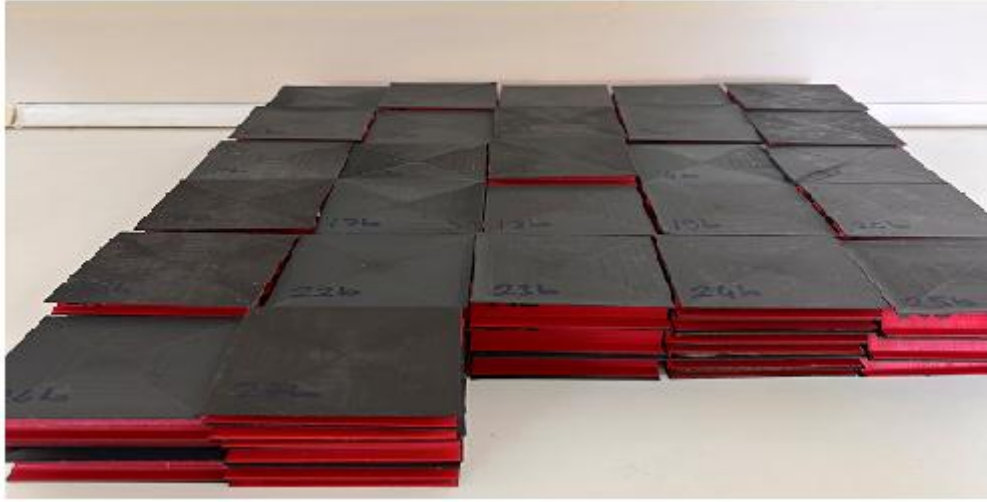
Şekil 3.7. a) Basma deneyi için hazırlanmış numunelerin yandan görünüşü b) Basma deneyi için hazırlanmış numunelerin üstten görünüşü
