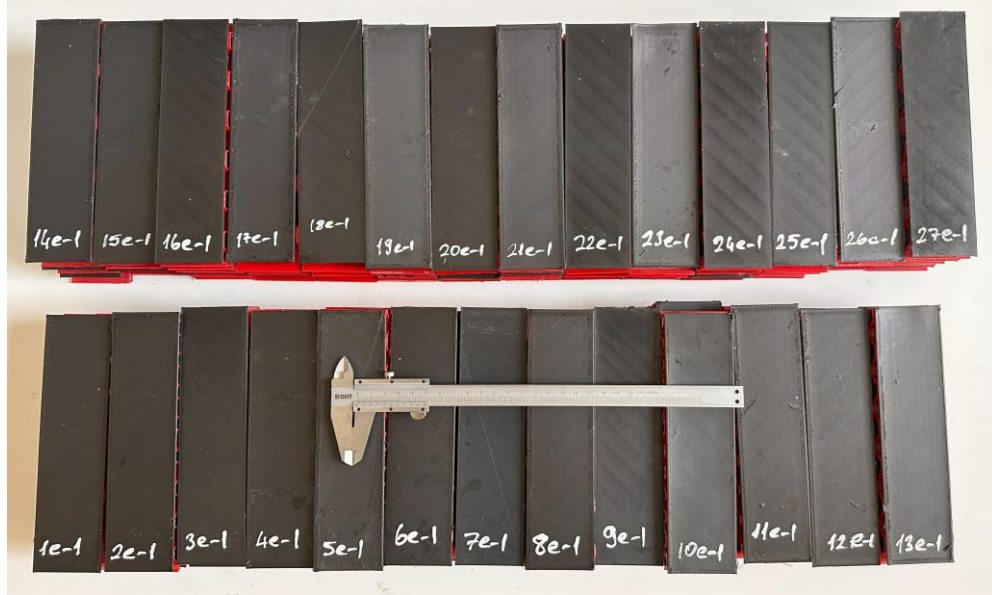
Şekil 3.20. Oda sıcaklığında 24 saat boyunca kürlen ve 0,5 MPa basınçta yapıştırılan 81 adet sandviç kompozit yapı numuneleri
