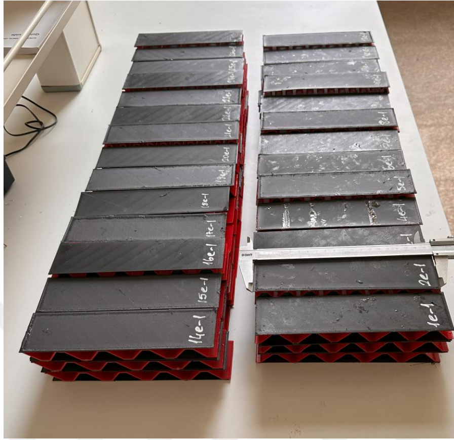
Şekil 3.21. A ve B de üç nokta eğme testi için her bir deney numarası için 3'er adet olmak üzere toplam 81 adet hazırlanmış numunelerinin farklı kesitlerden görünüşü
