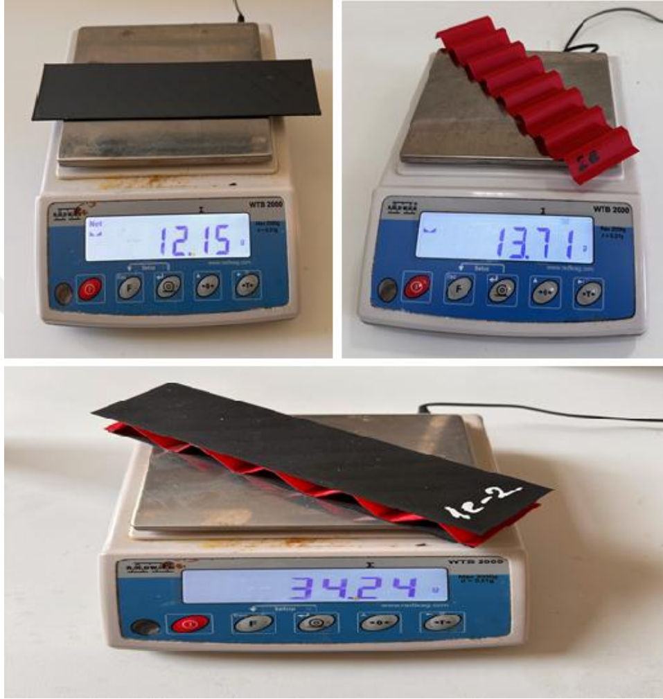
Şekil 3.17. Radwag WTB 2000 terazisi (Kapasite: 2000 gr, Hassasiyet: 0,01 gr)
