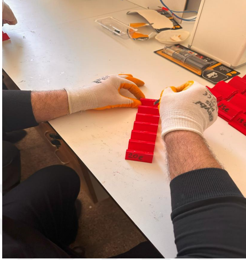
Şekil 3.18. Çekirdek numunelere spatula yardımıyla çift bileşenli epoksi esaslı yapıştırılması
