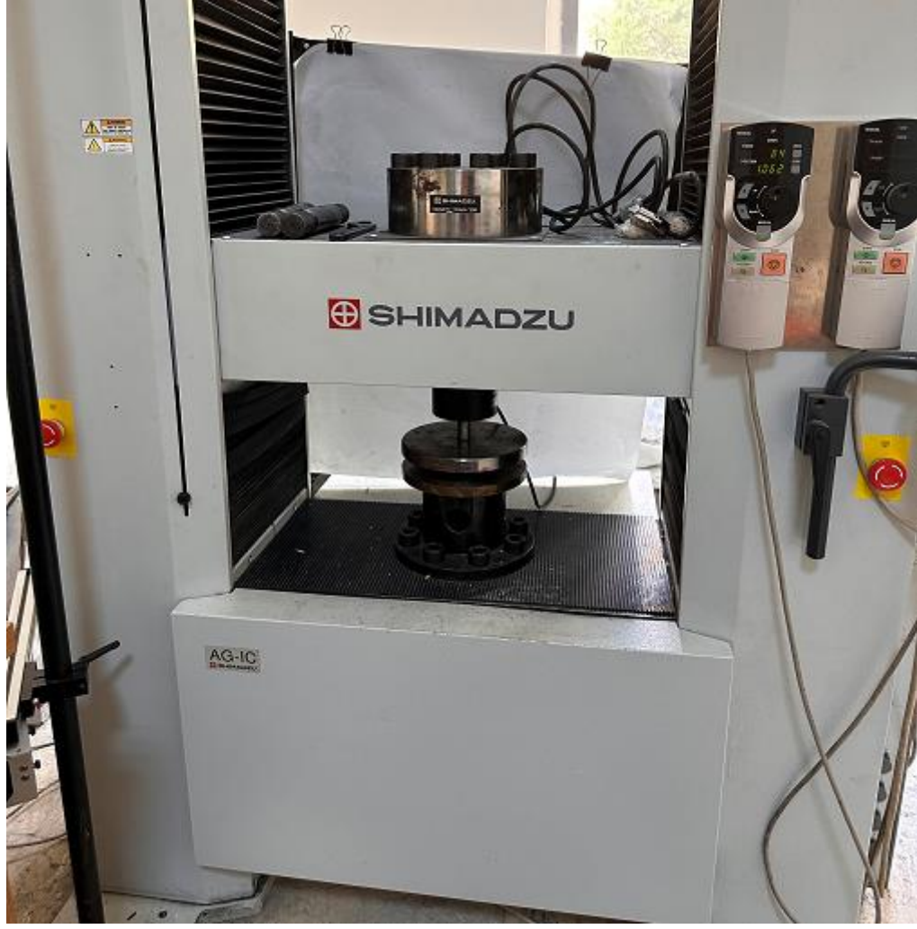
Şekil 3.9. Batman Üniversitesi Makine Mühendisliği Laboratuvarı'ndaki Shimadzu AG-IC model 250 kN cihazı
