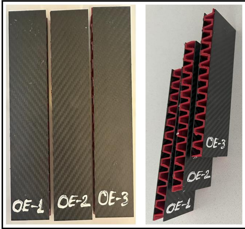
Şekil 4.56. Üç nokta eğme testi için hazırlanmış numunelerin üstten ve perspektif görüntüsü
