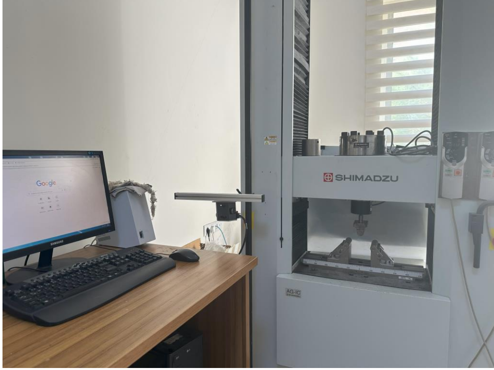
Şekil 3.22. Deneylerin yapıldığı Shimadzu AG-IC model 250 kN universal test cihazı
