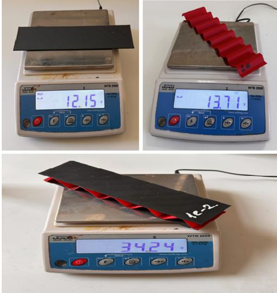
Şekil 3.17. Radwag WTB 2000 terazisi (Kapasite: 2000 gr, Hassasiyet: 0,01 gr)
