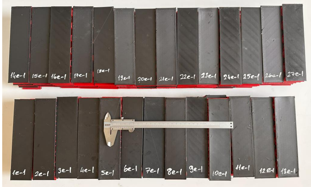
Şekil 3.20. Oda sıcaklığında 24 saat boyunca kürlenmiş ve 0,5 MPa basınçta yapıştırılan 81 adet sandviç kompozit yapı numuneleri
