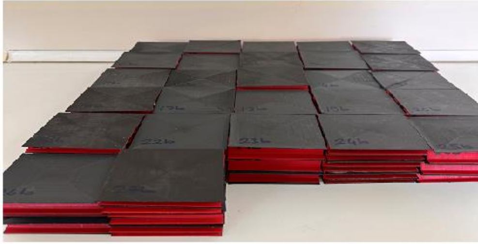
Şekil 3.7. a) Basma deneyi için hazırlanmış numunelerin yandan görünüşü b) Basma deneyi için hazırlanmış numunelerin üstten görünüşü
