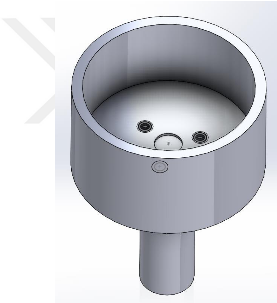
Şekil 2.20. Sıvı Ortamda Aşınma Testleri İçin Tasarlanan Kabin Üç Boyutlu Modeli
