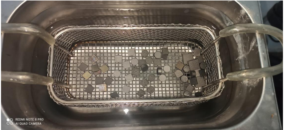
Şekil 2.9. Alaşımların Ultrasonik Banyo ile Temizlenme Sürecine Ait Görsel
