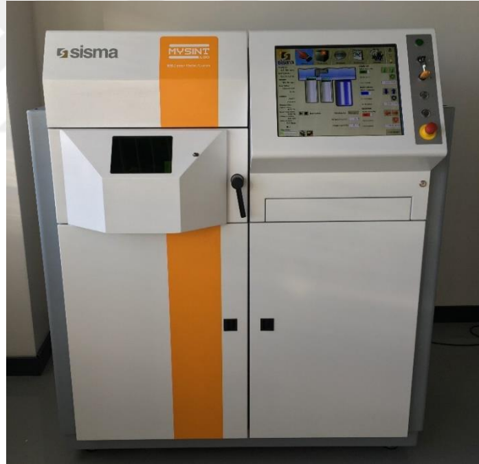
Şekil 2.2. Sisma MYSINT 100 Model Seçici Lazer Ergitme (SLM) Cihazının Genel Görünümü
