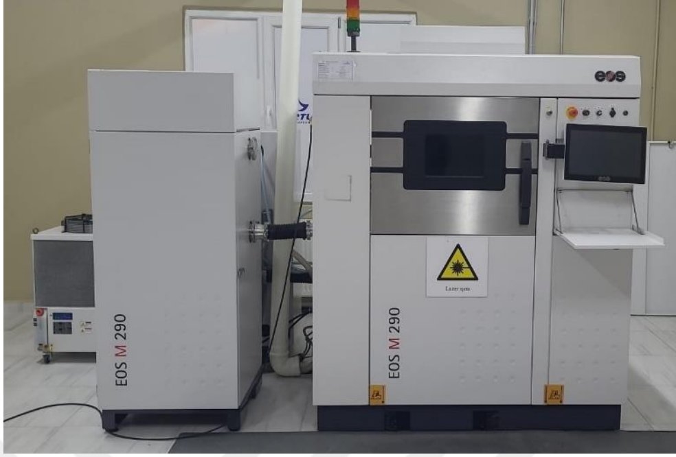
Şekil 2.1. EOS M 290 Model Seçici Lazer Ergitme (SLM) Cihazının Genel Görünümü
