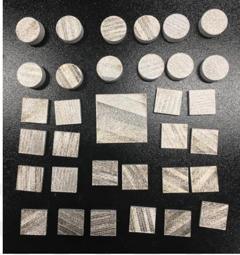
Şekil 2.4. Seçici Lazer Ergitme ile Üretilmiş CoCrWMo Alaşımının Üretim Sonrası Görünümü
