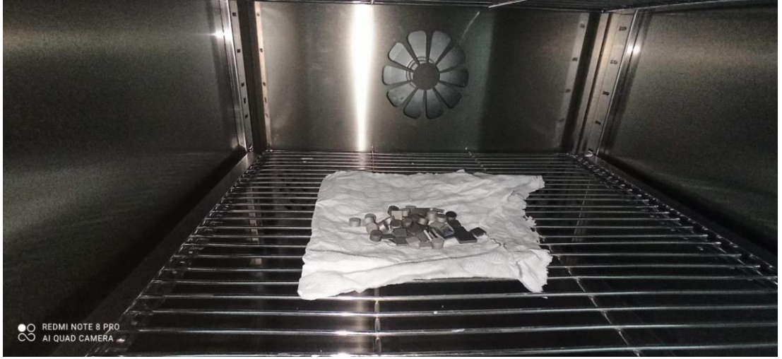
Şekil 2.10. Kaplama Öncesi Etüvde Kurutulan Alaşımların Görünümü
