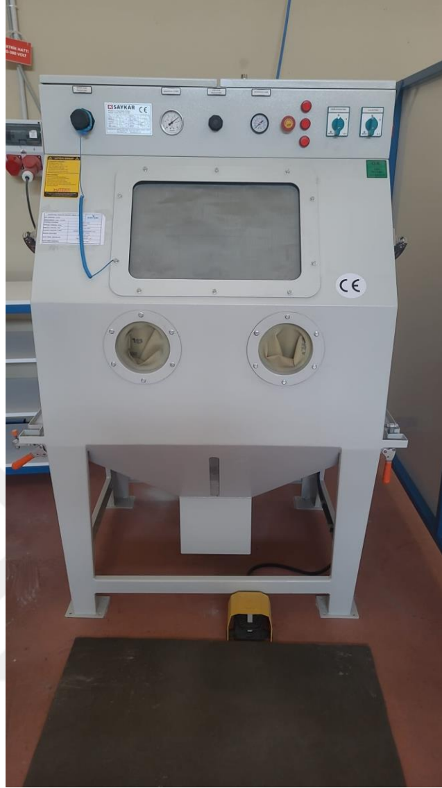
Şekil 2.5. SK 1000 Model Enjeksiyonlu Kumlama Makinesinin Genel Görünümü
