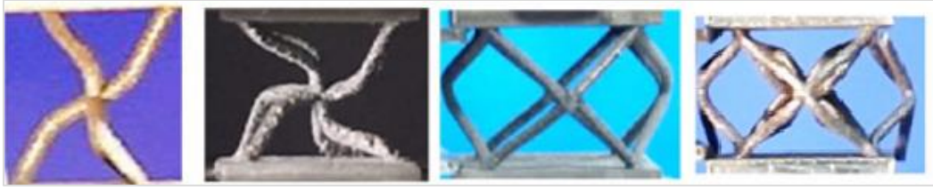
Şekil 2.54. Kagome, hacim, yüzey, yüzey ve hacim merkezli yapı bası testi [117]
