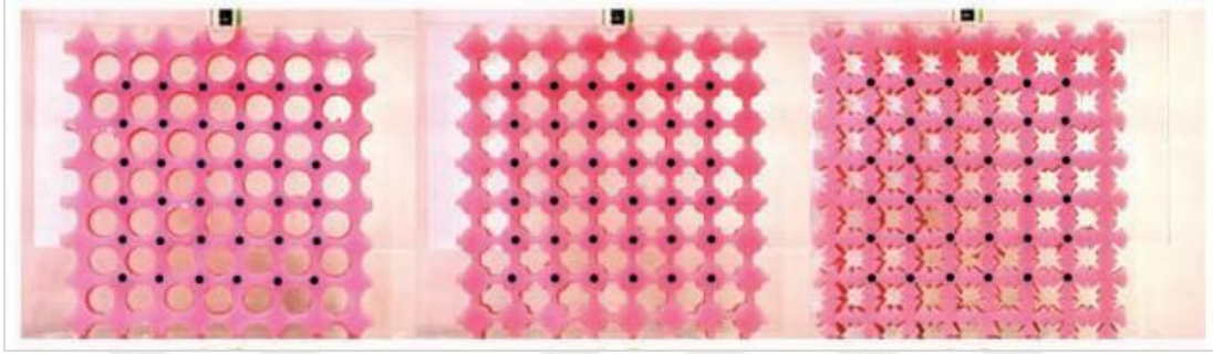
Şekil 2.18. Delikli desen yapıları metamatlreme örnekleri [77]
