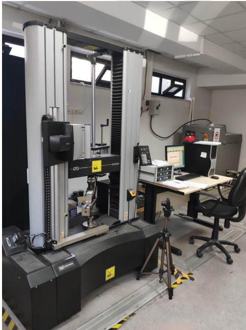
Şekil 3.13. Üç nokta eğme testlerini yapıldığı Instron 5582 cihazı
