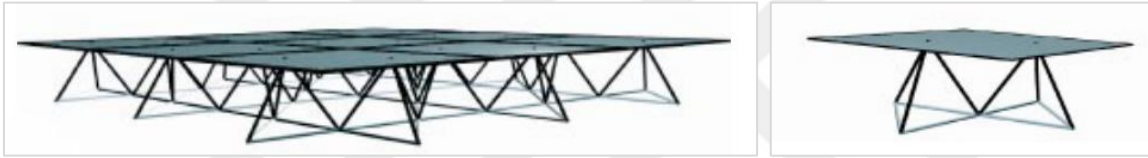
Şekil 2.3. Kagome plaka yapısı ve kagome birim hücre [28]
