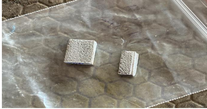
řekil 3.1: Bir Yüzeyi titreřimli dövölmüş ve ısıı işlem görmüş numune
