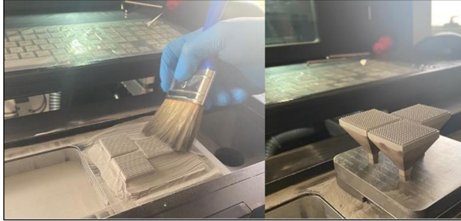
Şekil 3. 17. SLM yöntemiyle üretilimi tamamlanmış tabla üzerine bağlı destek elemanlarından ayrılmamış numuneler.
