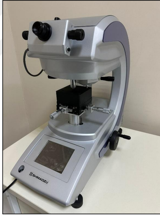
Şekil 3. 22. Shimadzu HMV G20 mikro sertlik ölçüm cihazı.
