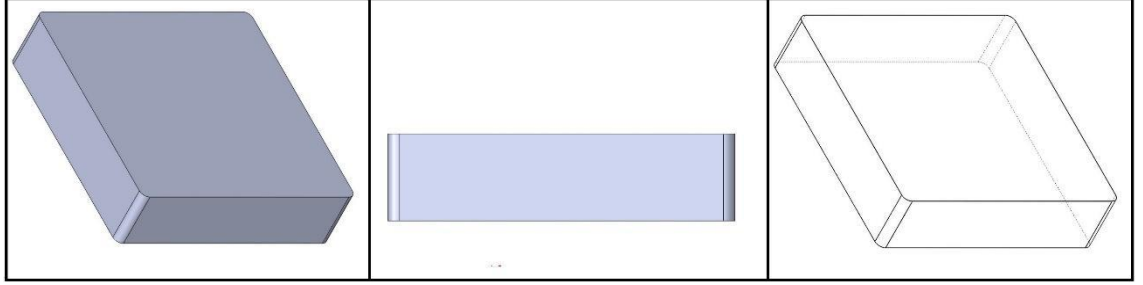
Şekil 3. 5. Poroz plaka numunelerin CAD modeli.
