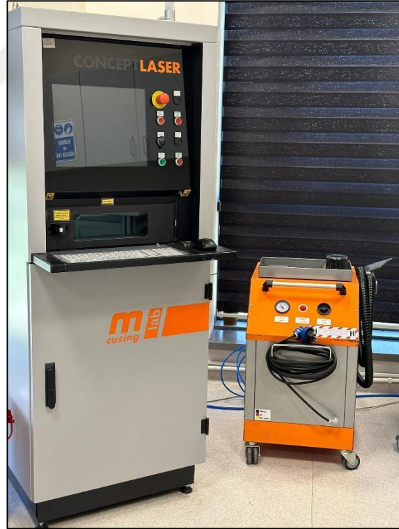
Şekil 3. 4. Concept Laser markalı MLab Cusing R model SLM cihazı.
