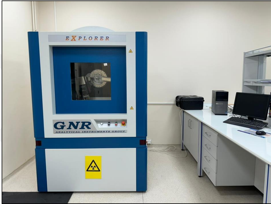
Şekil 3. 24. X-Işını kırınım (XRD) ölçer cihazı.
