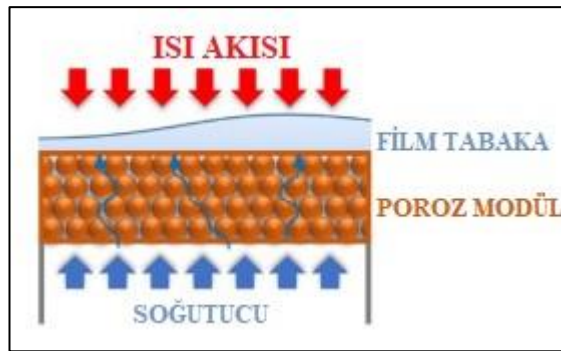
Şekil 1. 20. Terlemeli soğutma şematik gösterim (Jiang et al. 2017).
