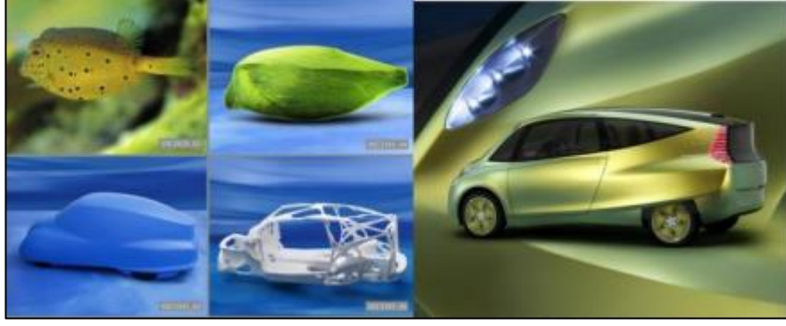
Şekil 1. 14. Kutu balıkları ve ağaçların büyümesinden esinlenerek tasarlanan otomobil (Gökmen 2024).
