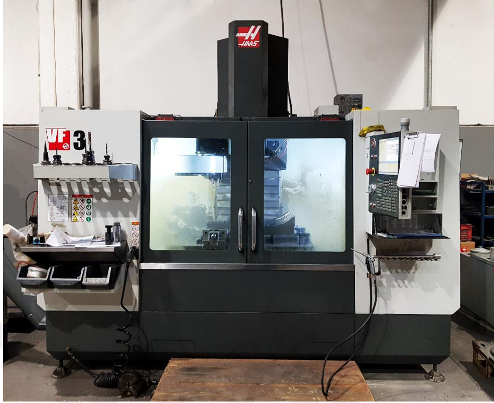
Şekil 3.8. Çekme numunelerinin talaş kaldırma işlemlerinin gerçekleştirildiği Haas marka VF3 model CNC freze tezgahı
