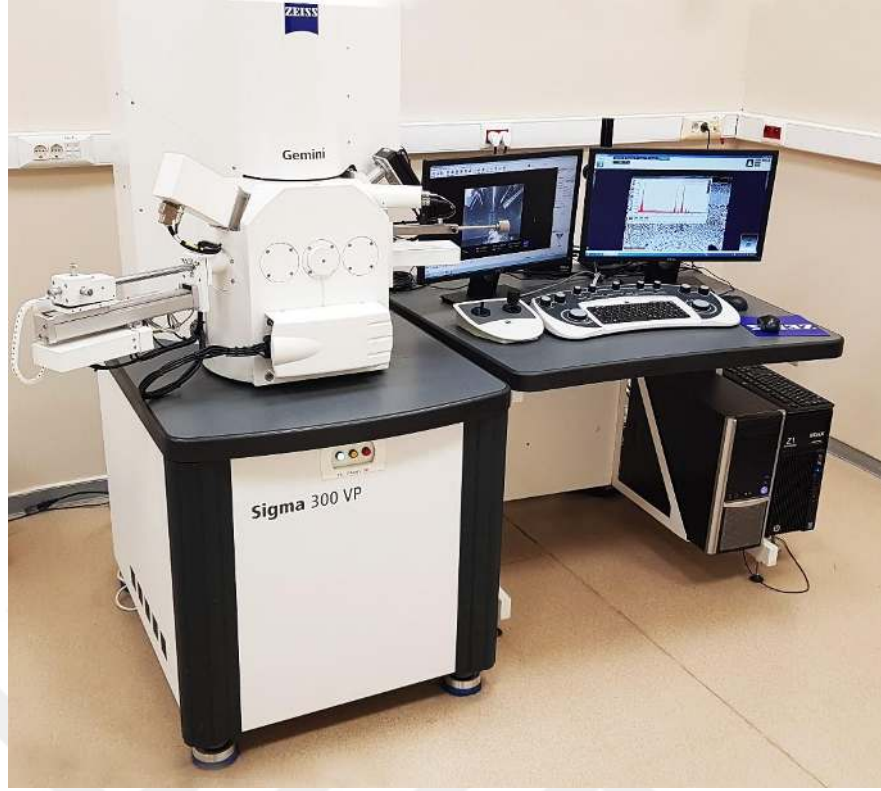
Şekil 3.41. Zeiss marka Sigma 300 VP model SEM cihazı
