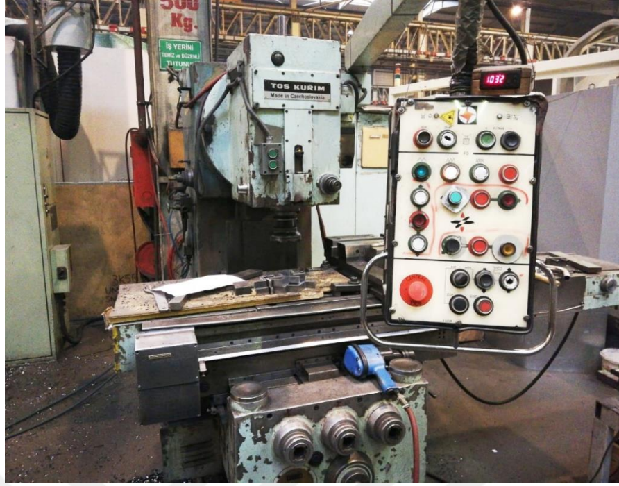
Şekil 3.9. Tos Kurim marka manuel freze tezgahı
