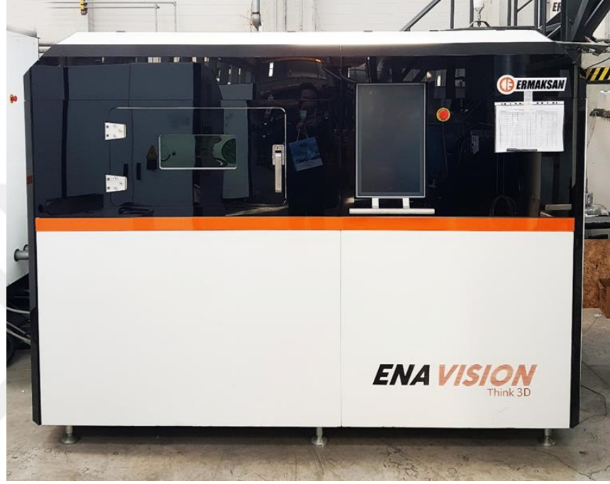
Şekil 3.2. Tüm numune üretimlerinin gerçekleştirildiği ENA 250 marka SLM tipi eklemeli imalat makinesi
