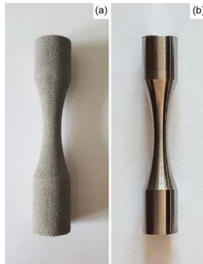
Şekil 3.16. Yorulma numunesi görüntüleri (a) işlenmemiş (b) tüm talaş kaldırma işlemleri tamamlanmış
