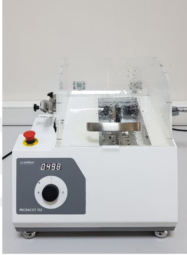
Şekil 3.29. Metkon Marka Miracut 152 Model Hasas Kesme Cihazı
