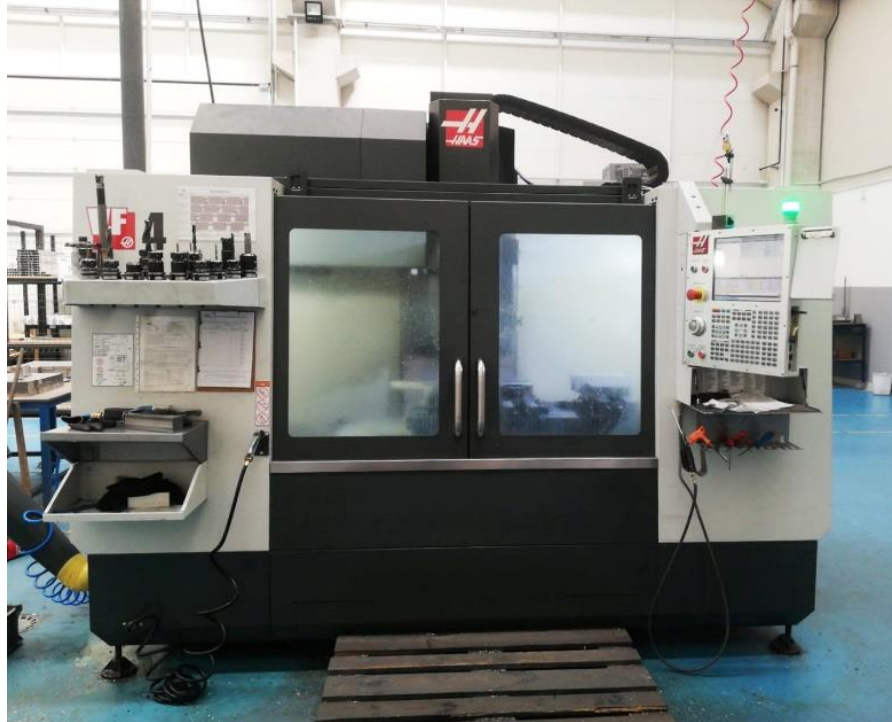
Şekil 3.12. Haas marka VF4 model CNC freze tezgahı
