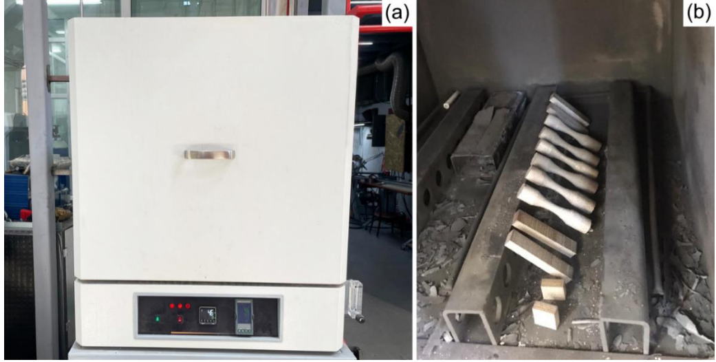
Şekil 3.19. (a) Protherm marka HLF 140 model ısıtım fırını (b) numunelerin ısıtım işlem öncesi fırın içinde alınan görüntüsü
