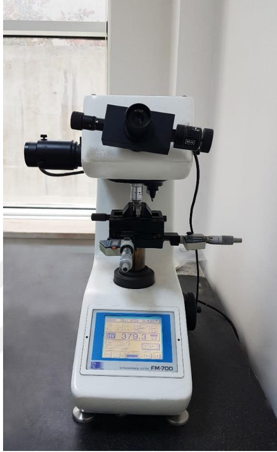
Şekil 3.28. Future Tech marka FM-700 model Vickers mikrosertlik ölçüm cihazı
