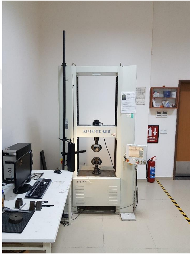
Şekil 3.27. Shimadzu marka AG-IS 100 kN model çekme cihazı
