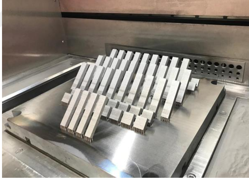
Şekil 3.5. Üç nokta eğme numuneleri ile farklı türden ikincil işlemlerde kullanılan numunelerin üretim sonrasında alınan görüntüsü
