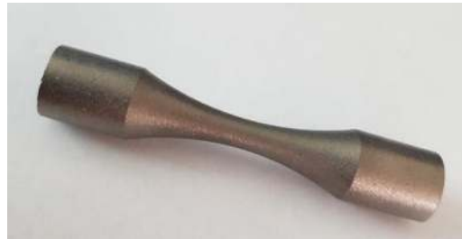
Şekil 3.25. SP işlemleri tamamlanmış YS2 kodlu numune görüntüsü
