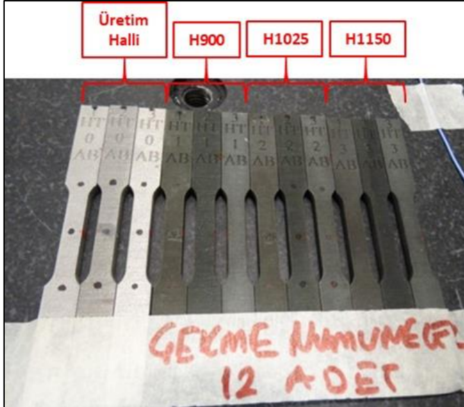
Şekil 4.2. EİT ile üretilmiş çekme testi numuneleri
