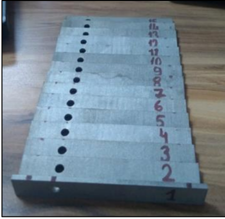
Şekil 4.3. EİT ile üretilmiş yorulma testi numuneleri
