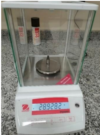
Şekil 3.4. Numunelerin hassas terazide kütlelerinin ölçülmesi
