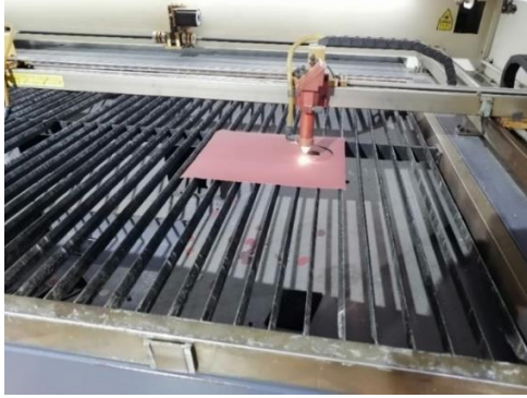
Şekil 3.3. Zımpara kağıdının (#600 tipi) lazerle kesilmesi
