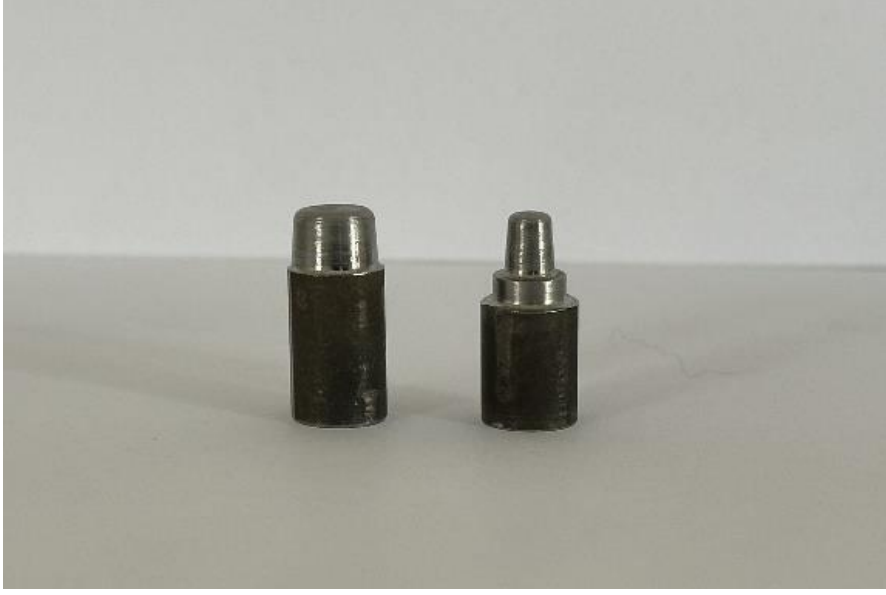
Şekil 3.2: Yapılan tasarım sonrası CNC cihazında üretimi yapılan metal güdükler
