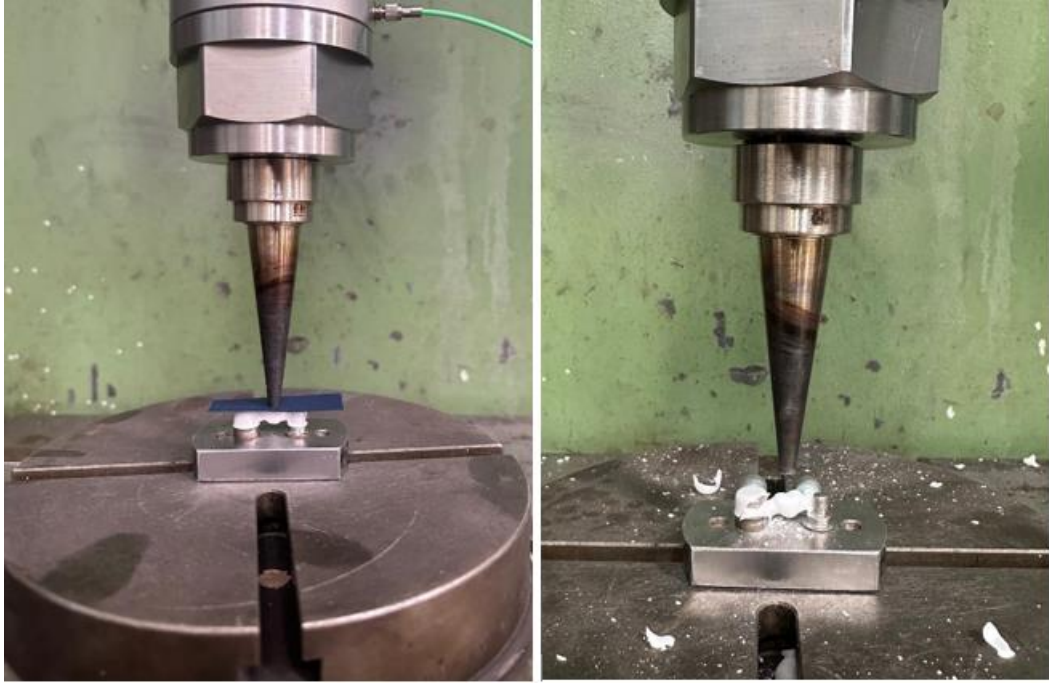
Şekil 3.32: Zirkonyum örneklerin kırılma öncesi ve sonrası
