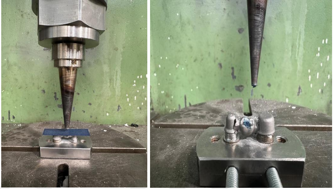
Şekil 3.23: Co-Cr örneklerin kırılma öncesi ve sonrası
