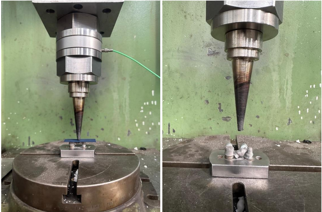
Şekil 3.24: Titanyum örneklerin kırılma öncesi ve sonrası
