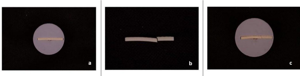
Şekil 3.5: a) Kırık örneklerin tamir edilmiş hali b) Kırık örnek c) Kırık örneklerin tamir edilmeden önceki hali
