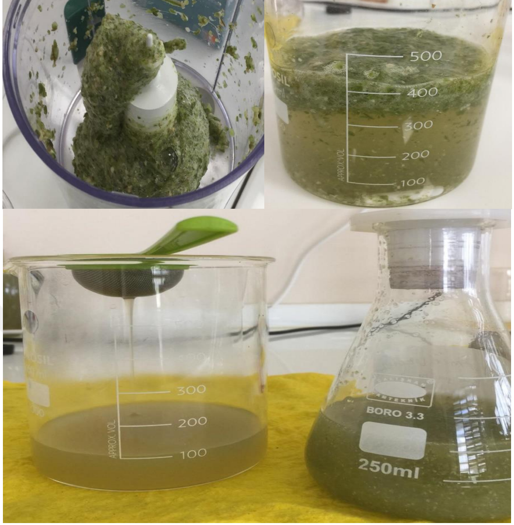
Şekil 3.2. Ağırlıkça Bamyas: Destile su 50:350 Bamyas egzopolimerik maddesinin elde edilmesi.
