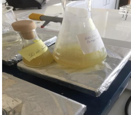
Şekil 3.7. 50 mL YSS sıvı 50 mL ağırlıkça 50:350 Bamya: Destile su egzopolimerik maddesi ile hazırlanmış 100 mL’lik BYSS.
