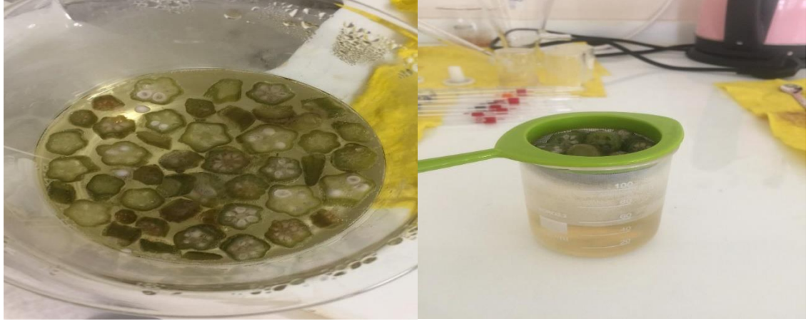
Şekil 3.5. Ağırılıkça Bamyada Destile su 9:63 Bamyada egzopolimerik maddesinin elde edilme süreci.
