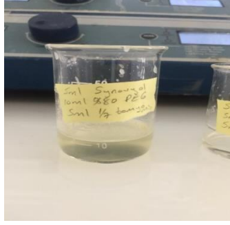
Şekil 3.11. 5 mL YSS 5 mL ağırlıkça 9:63 Bamya: Destile su egzopolimerik maddesi ve 10 mL %80'lik PEG çözeltisi ile hazırlanmış 20 mL'lik BPYSS.
