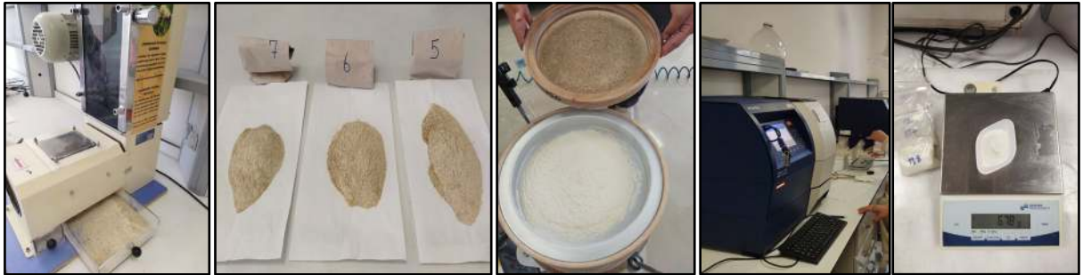
Şekil 3.16. Düşme sayısı analizi için öğütme, eleme ve un nemlerinin belirlenmesi işlemi
