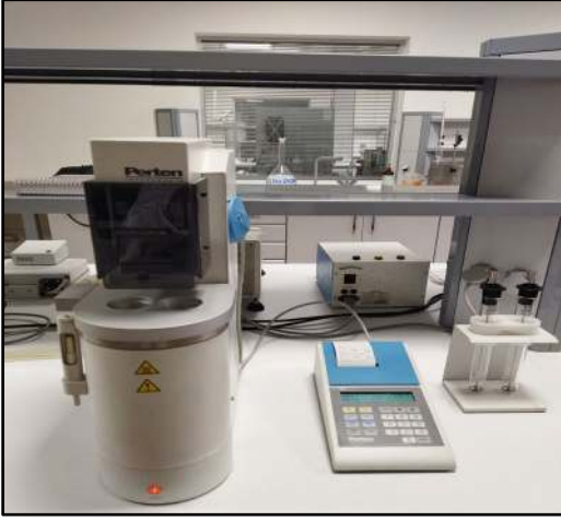
Şekil 3.17. Falling number cihazında düşme sayısı analizi
