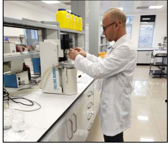
Şekil 3.17. Falling number cihazında düşme sayısı analizi
