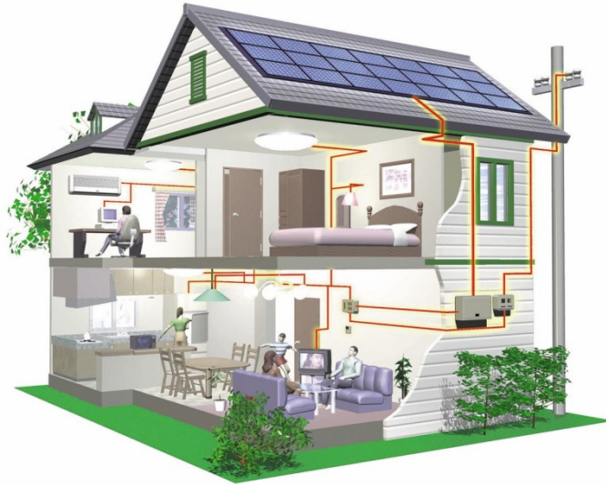
Şekil 3.21 Fotovoltaik panellerin konutta kullanım diyagramı.
