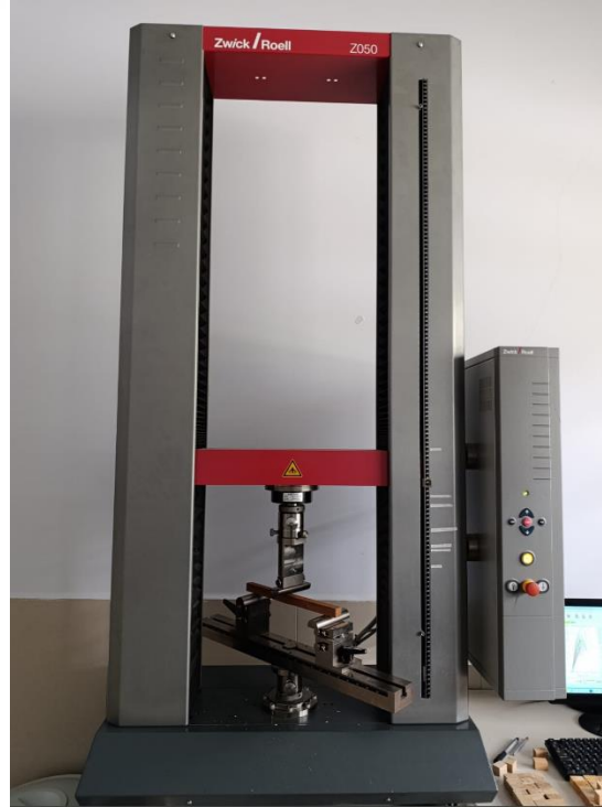
Şekil 2. Mekanik ve fiziksel testlerde kullanılan üniversal test cihazı
