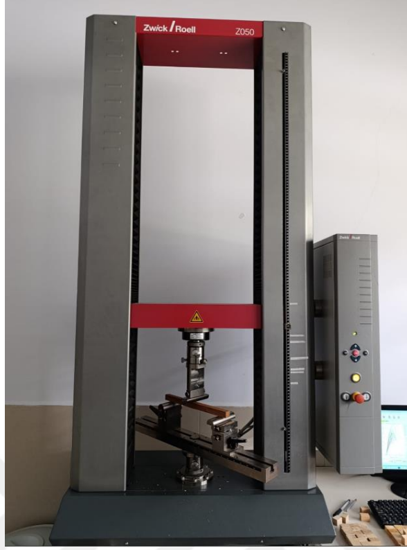
Şekil 2. Mekanik deneylerin uygulanmasında kullanılan üniversal makine
