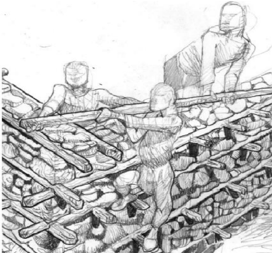
Şekil 3.1 Düğmeli evlerin yapım tekniğini gösteren bir çizim. ( Kavas, 2011: 30)
