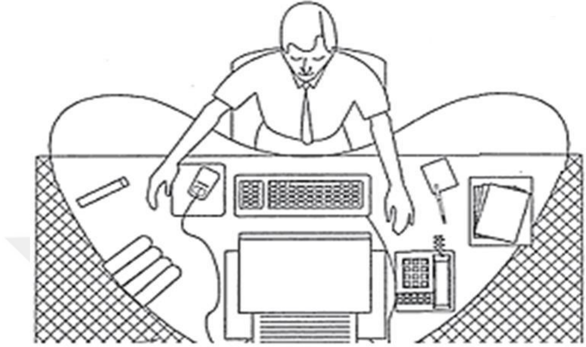
Şekil 12. İdeal olarak tasarlanmış alışma alanı ve kullanım yüzeyi
