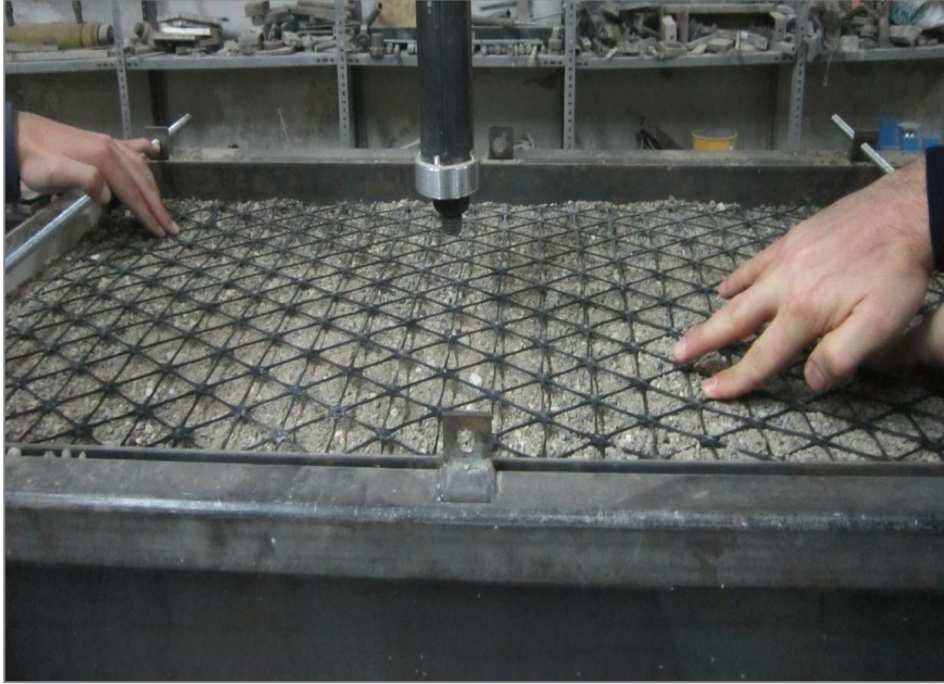
Resim 3.4. Geogrid donatının yerleştirilmesi
