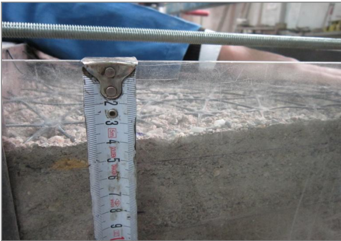
Resim 1.5. Geogridin farklı derinliklerde serilmesi
