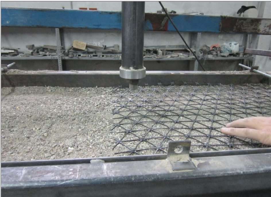
Resim 1.4. Geogridin farklı uzunluklarda serilmesi
