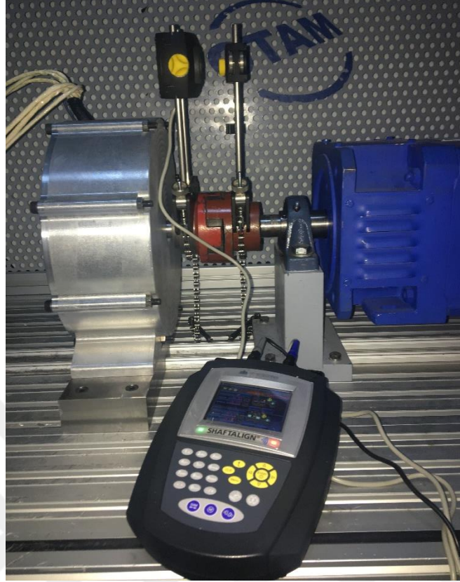
Şekil 3.41. Hizalama cihazının motor kaplinlerine bağlı durumu
