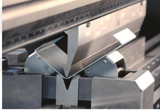
Şekil 3.7. Çelik levhaların presle şekil verme yöntemiyle şekillendirilmesi [43]
