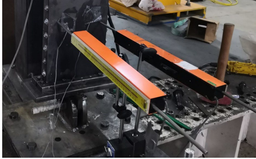
Şekil 3.9. Deneysel çalışmada kullanılan LVDT' lerin görüntüsü
