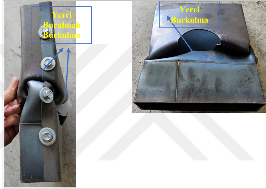
Şekil 4.18. CU240-t2-L300-S50-A0.4 numunesinin deneyden sonraki görüntüsü
