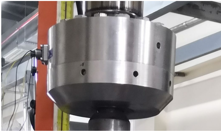
Şekil 3.10. Deneysel çalışmada kullanılan Loadcell görüntüsü
