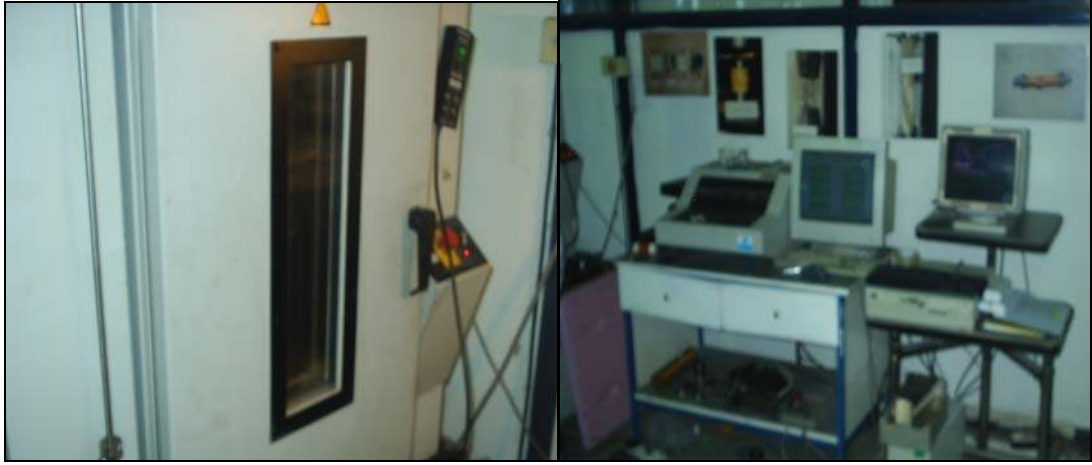
Resim 7.3. Sol; Instron çekme cihazının fırını , sağ; strain gage ve gerilme şekil değiştirme datalarının toplandığı bilgisayarlar.
