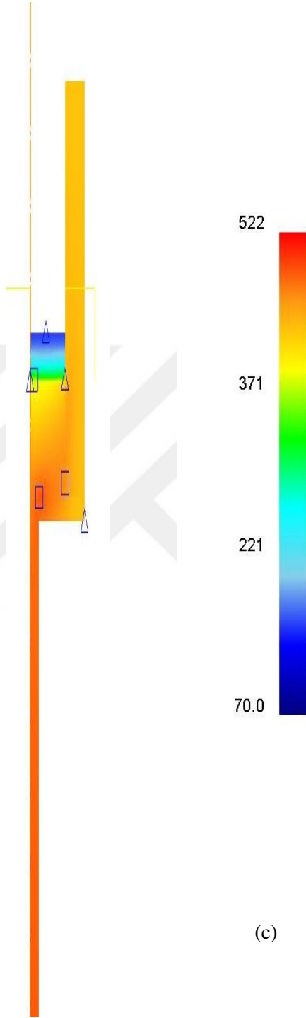
Şekil 4.3. 3 nolu simülasyon sonuçları: (T= 500°C V= 4mm/s) (a) DEFORM yazılımından alınan grafik, b) DEFORM yazılımının oluşturduğu grafikten YSA modellemesinde kullanılmak üzere seçilmiş verilere ait grafik, c) Simülasyona ait resim ve sıcaklık skalası)
