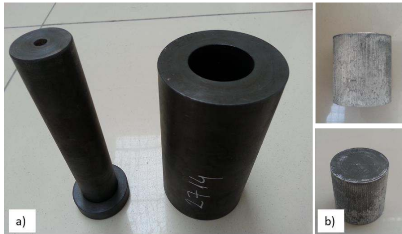
Fotoęraf 6.3. Soęuk presleme kalıp takımı (a), sıkıřtırma sonrası retilen biyet numune (b)
