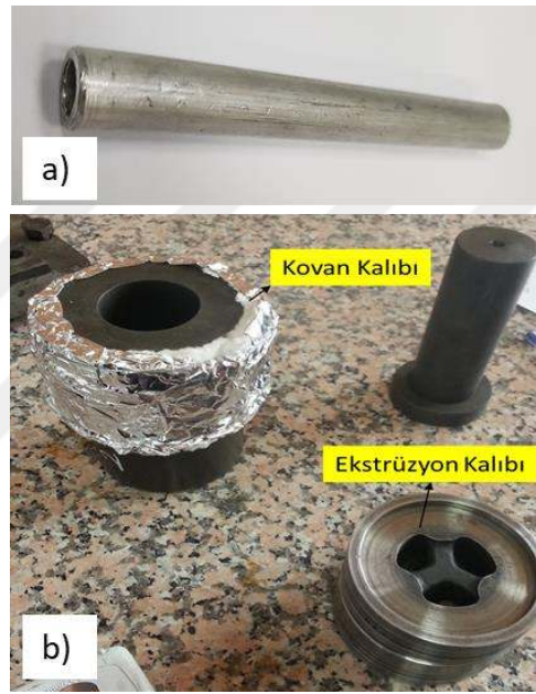
Fotoğraf 6.4. Ekstrüzyon sonrası üretilen kompozit profil numune (a), Ekstrüzyon kalıbı (b)
