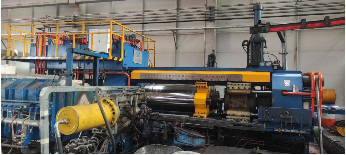
Şekil 3.5. Deney profilinin elde edilmesinde kullanılan alüminyum ekstrüzyon pres.
