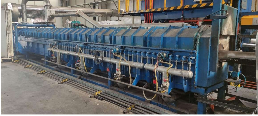
Şekil 3.4. Ön ısıtma işlemi esnasında kullanılan biyet fırını.
