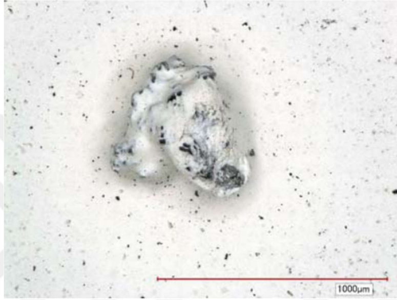
Şekil 2.14. Kuyruklu yıldız kusuru (Columbus ve Fourmann, 2017).
