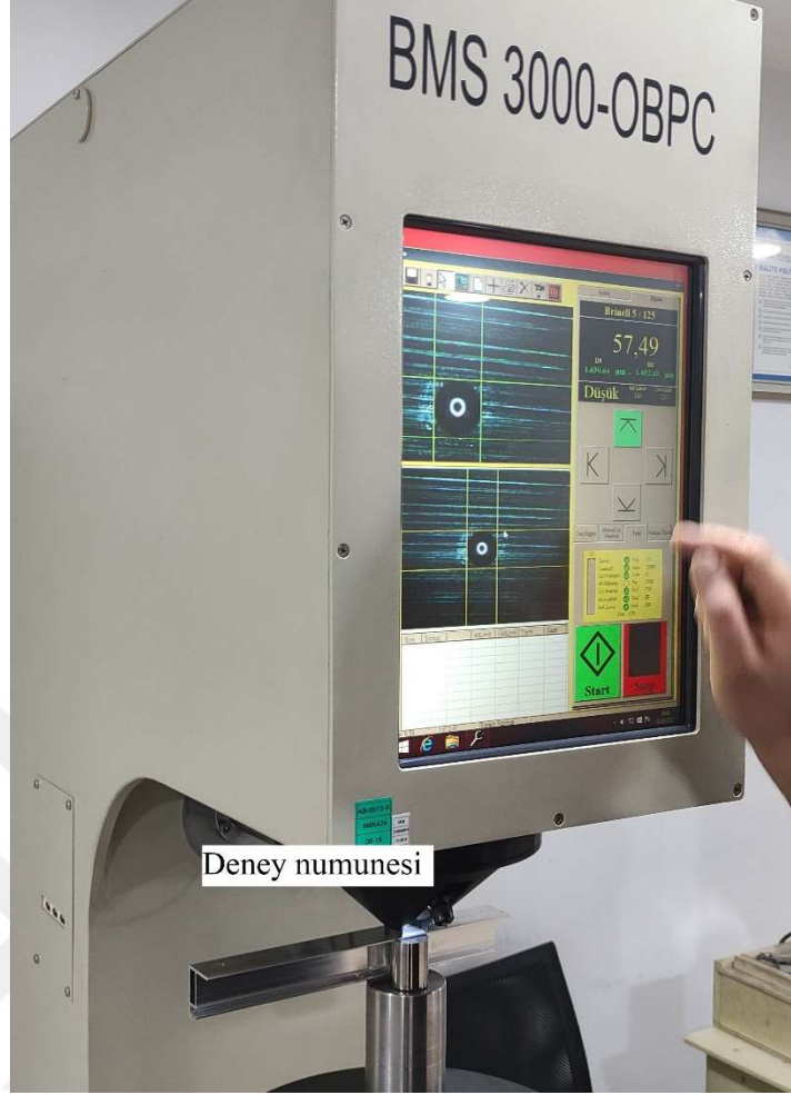
Şekil 3.9. Brinell sertliği ölçüm cihazı.
