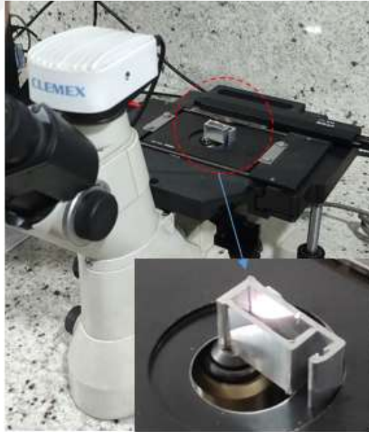
Şekil 3.12. Mikroyapı kontrollerinin yapıldığı optik mikroskop.
