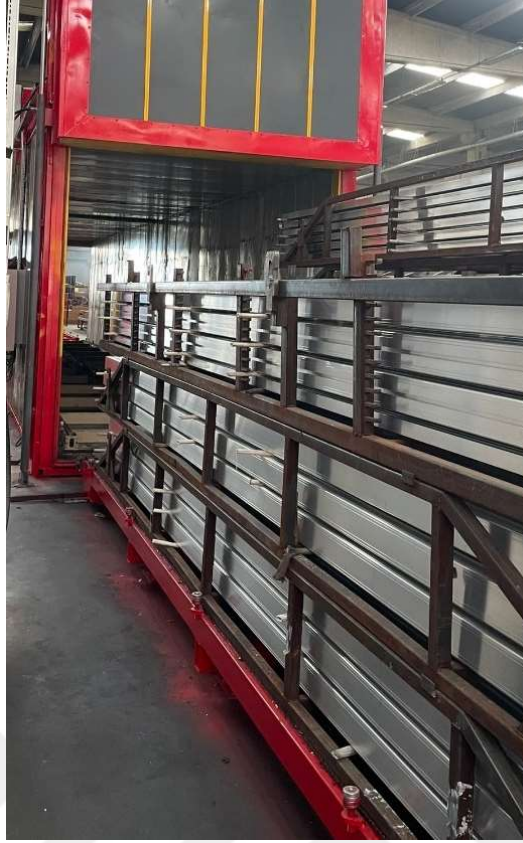
Şekil 3.7. Yapay yaşlandırma prosesinin yapıldığı termik fırın.
