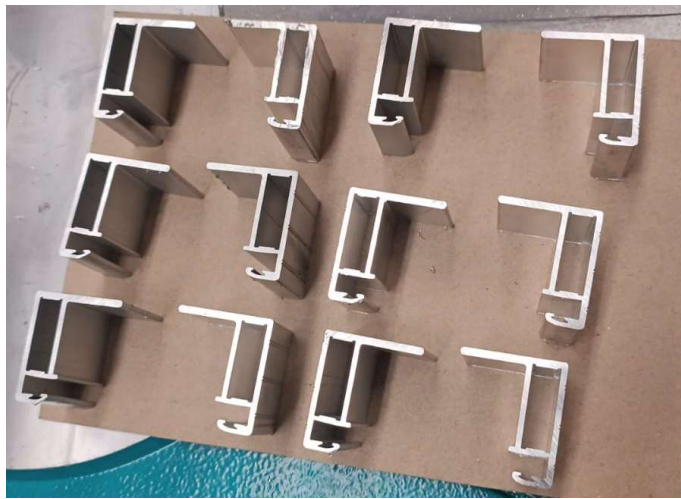
Şekil 3.8. Sertlik ölçümü ve mikroyapı kontrolü için kesilen numuneler.
