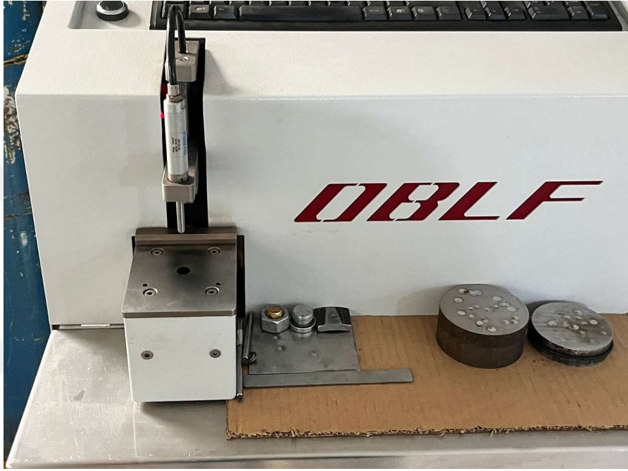
Şekil 3.1. Alaşımın uygunluğunu ölçmede kullanılan spektrometre.
