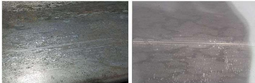
Şekil 2.13. Yüzey yırtılması meydana gelen profil (URL-4).
