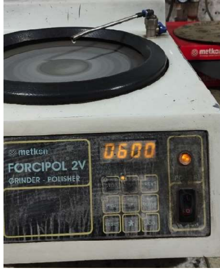
Şekil 3.11. Deney numunelerinin zımparalandığı zımpara makinesi.
