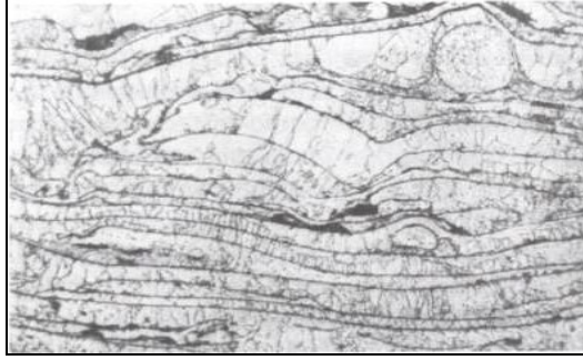
Resim 2.2. Düşük püskürtme yoğunluğunda üretilmiş bir parçanın yapısı [4]
