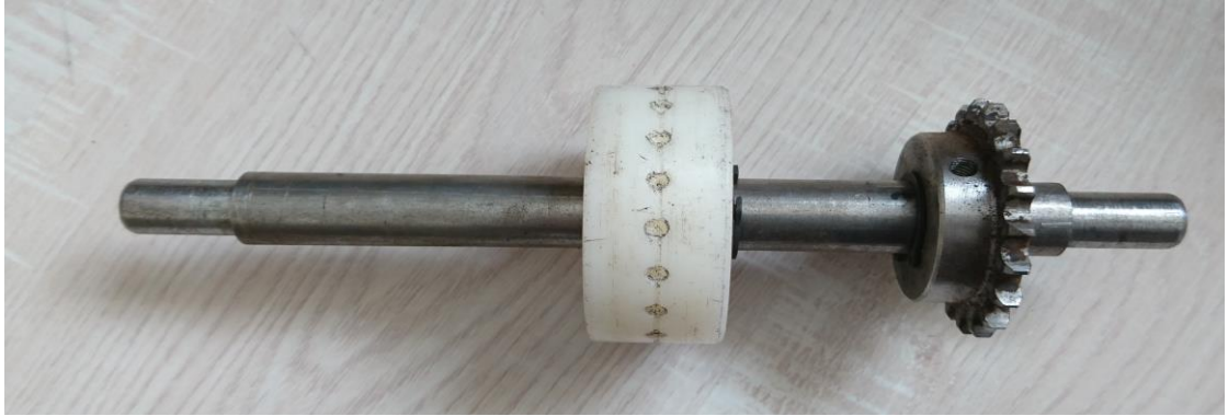
Şekil 3.3. Ekici düzen mili, makara ve dişli bağlantısı
