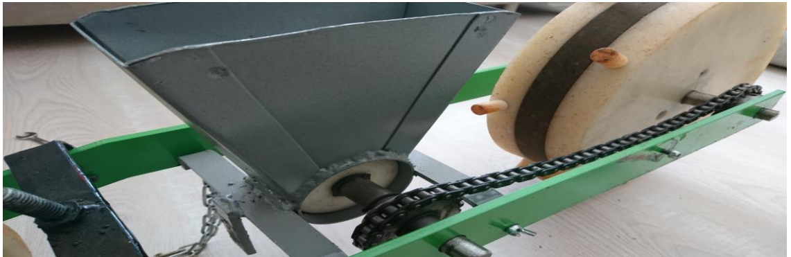
Şekil 3.4. Ekim makinasının ekici düzeninin montajı
