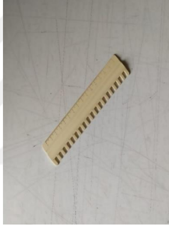
Görsel 4.81. Ayşenur SAKÖNDER, 2023, çözgü ipliklerinin düzeltilmesi amacı ile kullanılan tarak
