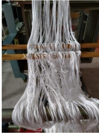
Görsel 4.85. Ayşenur SAKÖNDER, 2023, manuel dokuma makinesine aktarılan çözgü ipliklerinin ilk hali
