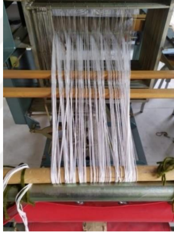
Görsel 4.87. Ayşenur SAKÖNDER, 2023, manuel dokuma makinesine aktarılan çözgü ipliklerinin plastik tarak yardımı ile düzeltilme işlemi sonrası
