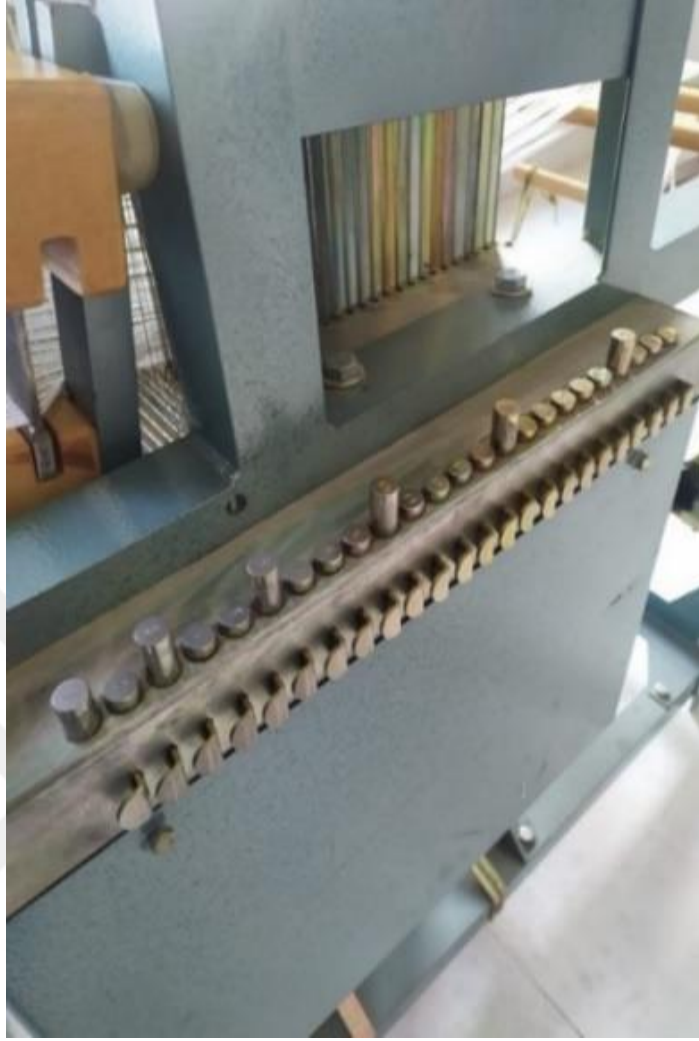
Görsel 4.89. Ayşenur SAKÖNDER, 2023, manuel dokuma makinesi üzerinde armür planlarının tuş sistemi ile hazırlanması
