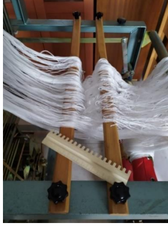
Görsel 4.86. Ayşenur SAKÖNDER, 2023, manuel dokuma makinesine aktarılan çözgü ipliklerinin plastik tarak yardımı ile düzeltilme işlemi
