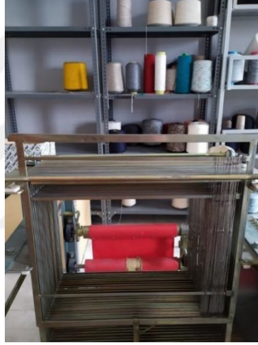
Görsel 4.78. Ayşenur SAKÖNDER, 2023, manuel dokuma makinesinin çerçeveleri-2
