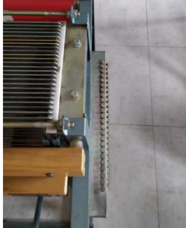
Görsel 4.79. Ayşenur SAKÖNDER, 2023, manuel dokuma makinesinin tuş sistemi
