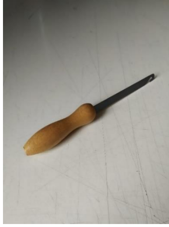
Görsel 4.80. Ayşenur SAKÖNDER, 2023, çözgü ipliklerinin gücü tellerinden geçirilmesi işleminde kullanılan tahar çekeceği
