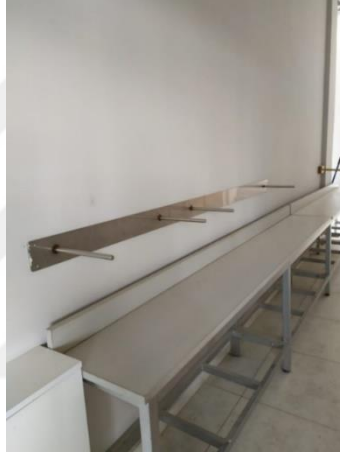
Görsel 4.84. Ayşenur SAKÖNDER, 2023, çözgü ipinin çekildiği duvara sabitlendirilmiş demir düzenek
