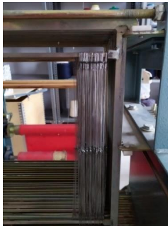
Görsel 4.76. Ayşenur SAKÖNDER, 2023, manuel dokuma makinesinin gücü telleri
