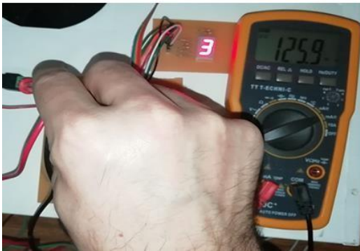
Şekil 4.8. Aspiratörün çalışma durumlarına göre devreden geçen akımın ölçülmesi
