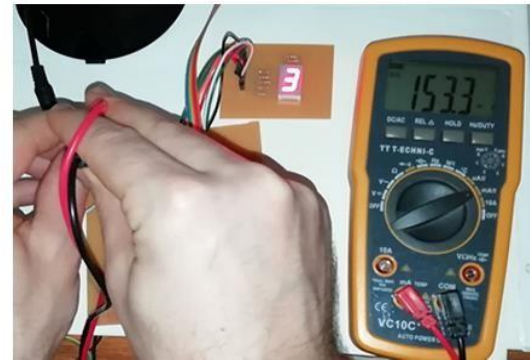
Şekil 4.8. Aspiratörün çalışma durumlarına göre devreden geçen akımın ölçülmesi
