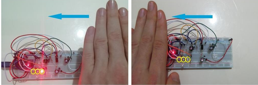
KADEME 1 LED'i yanıyorken elin SAĞDAN SOLA hareket ettirilmesi ve KADEME 1 LED'inin sönmesi.
